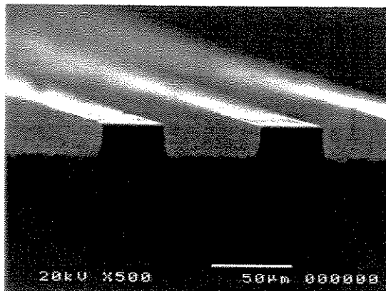
Figura 5.52. Foto por microscopia eletrônica do perfil da corrosão após processo de limpeza por microondas. Condições do processo de limpeza : 640 W, 15min.
