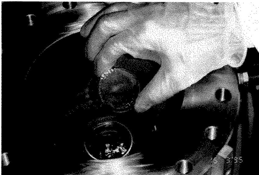
Figura 4.4 - Introdução do  $\text{B}_2\text{O}_3$  no cadinho de crescimento.
