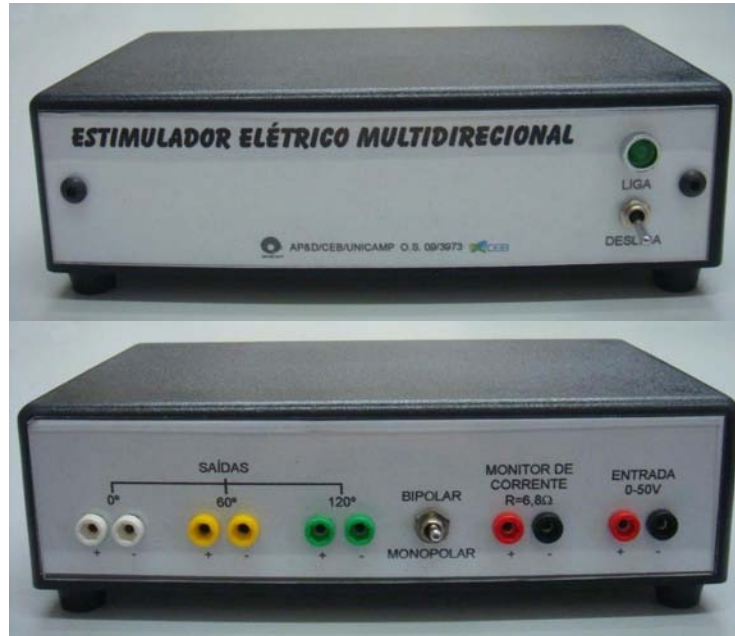
Figura 3.10 – Estimulador elétrico multidirecional desenvolvido no CEB que permite selecionar a forma de onda (pulsos retangulares de tensão mono e bipolar). Possui três saídas (uma para cada direção de estimulação), um monitor de corrente e uma entrada para a fonte variável de tensão.
