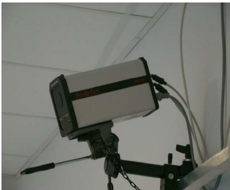
Figura 4: Uma das oito câmeras *ProReflex* MCU 120 do laboratório de marcha do QMH
