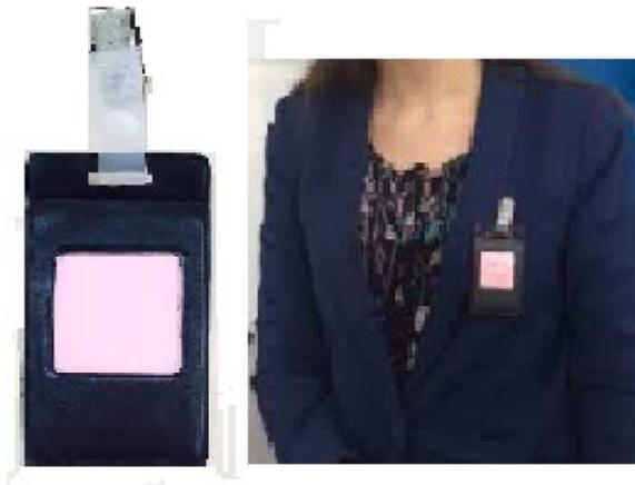
Figura 3.8 - Dosímetro pessoal em formato de crachá utilizado no tórax.
