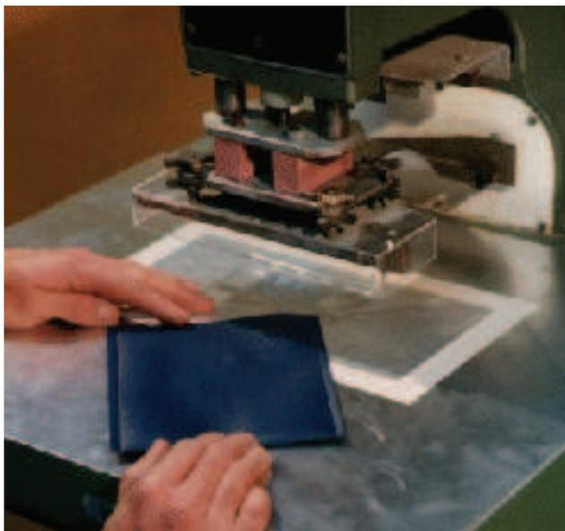
Figura 2.2: Foto da utilização da máquina de solda de polímeros
