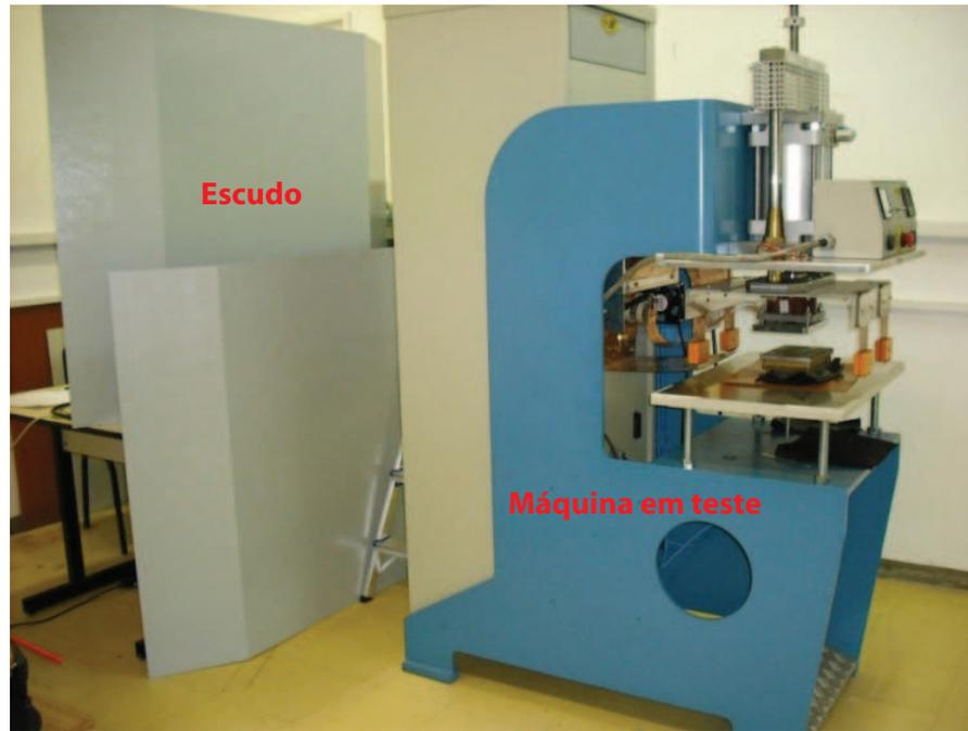
Figura 5.8: Foto a máquina de solda S12 KW-TV<sup>®</sup>, do lado esquerdo pode-se observar o escudo feito para proteção.
