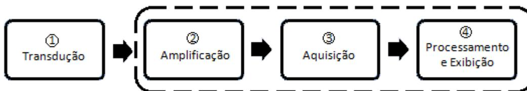
Figura 4.1 – Etapas necessárias para realizar a calibração dinâmica.
