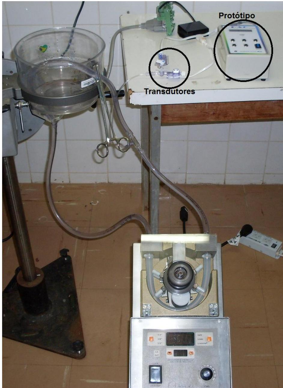
Figura 4.19 – Aparato experimental para testes de calibração dinâmica.
