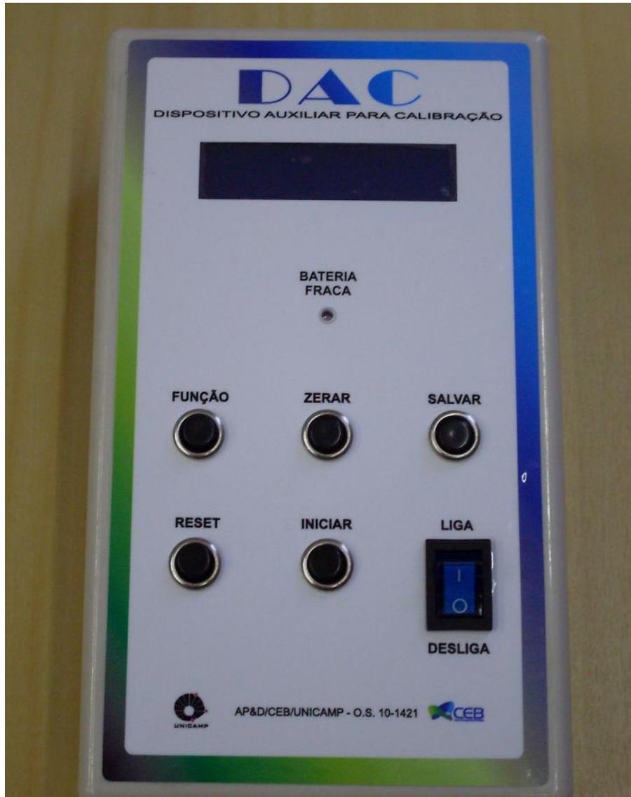
Figura 4.6 – Registro fotográfico do protótipo do DAC.
