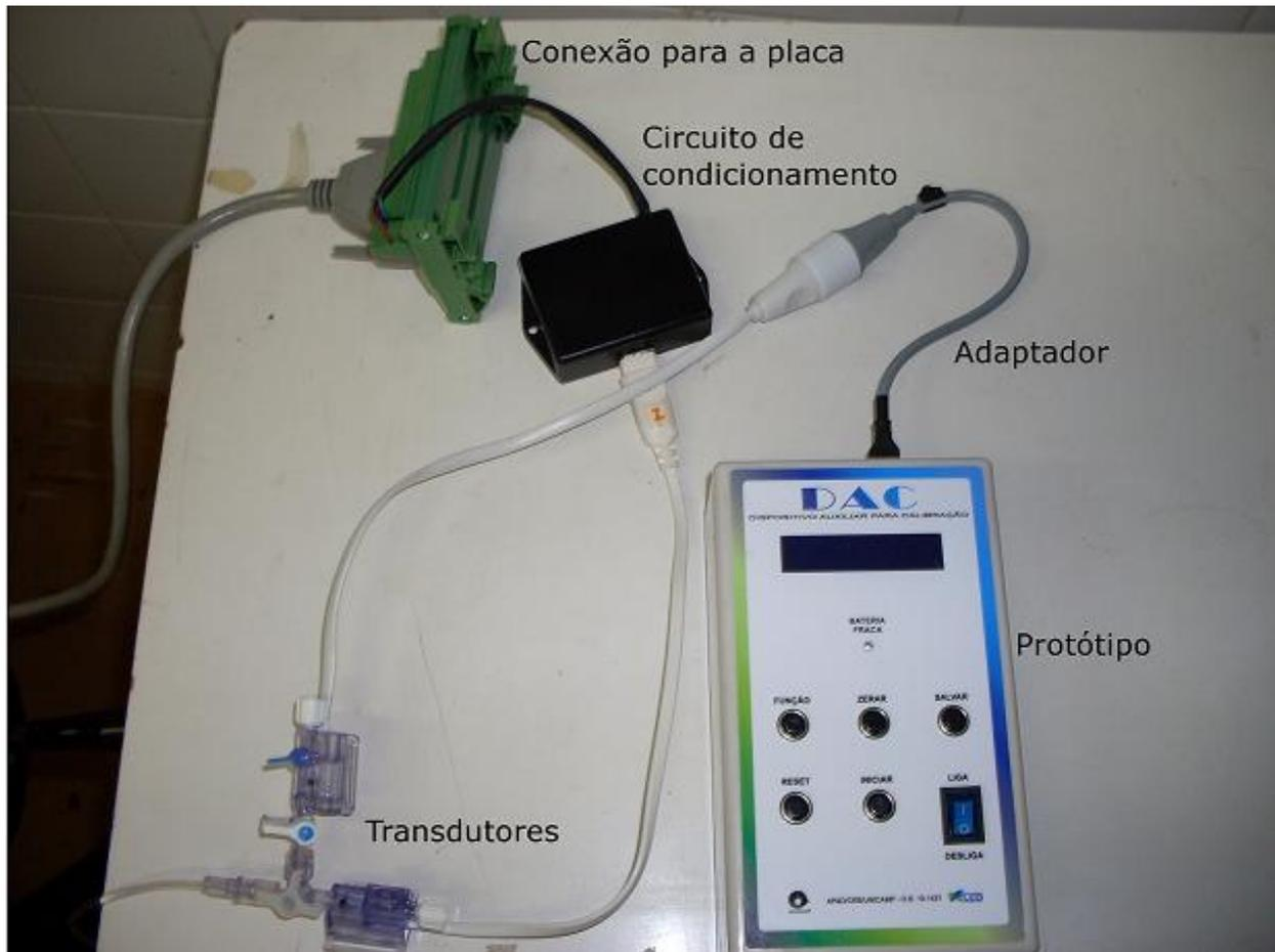
Figura 4.17 – Ligações dos transdutores para realização de testes de calibração dinâmica.
