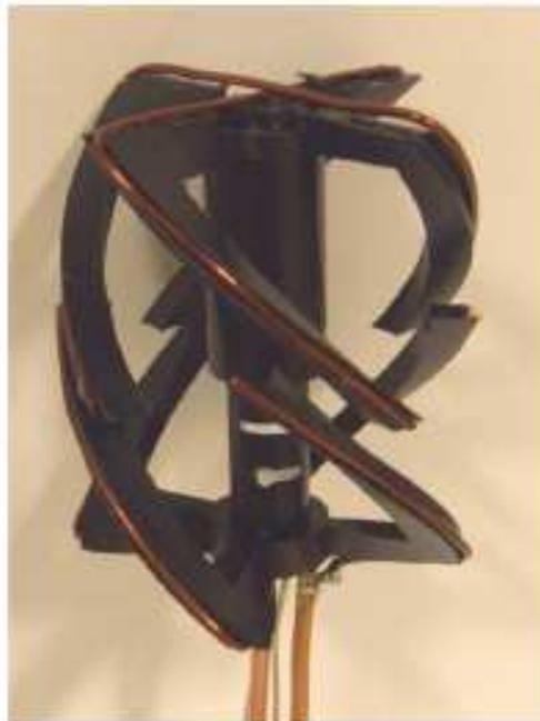
Figura VI-1: Configurações de antenas estudadas, antena hélice quadrifilar [61]. Esta antena apresenta ganho de cerca de 5 dB e boa relação frente costa, sendo empregada em sistemas de comunicações espaciais.
