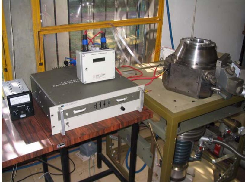
**Figura 8.1** Instalação final do medidor de corrente à bancada
