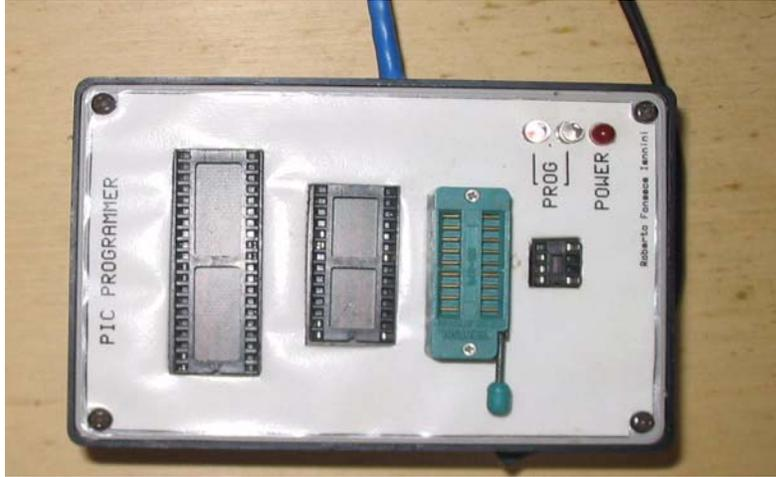
**Figura 4.1 Gravador para a família PIC construído para este projeto**
