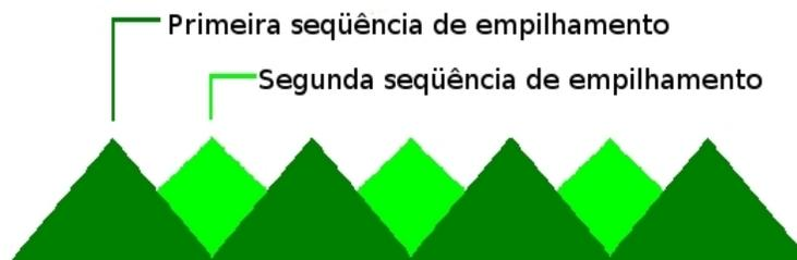
Fig. 7.23: Forma de empilhamento em cones alternados
