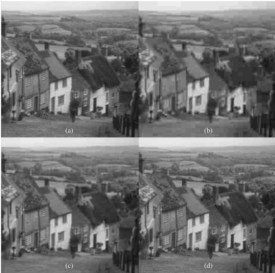
Fig. 5.7: Resultados visuais obtidos para a imagem Goldhill com o método proposto: (a) Imagem original, (b) com 0,25 bpp, (c) com 0,5 bpp e (d) com 1 bpp.
