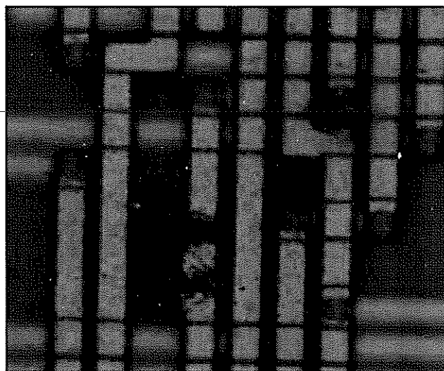
Figura 7.20. Imagem das secções de metal 2 queimadas pelo feixe laser para corrigir o defeito de funcionamento de Neuron .
