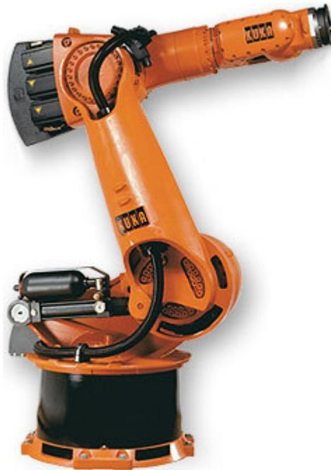
Fig. 1.4 – Braço robótico Kuka KR 500 570 PA/1
