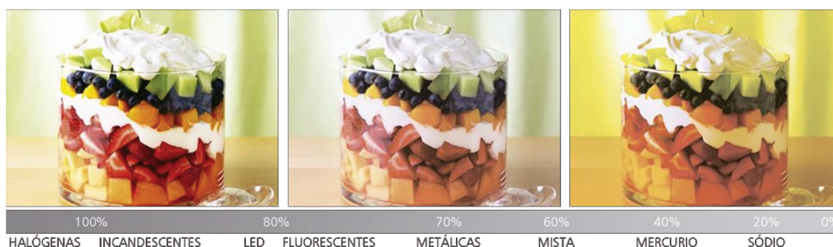
Figura A.13 – Variação na reprodução de cores de diferentes tipos de fonte de luz [104]
