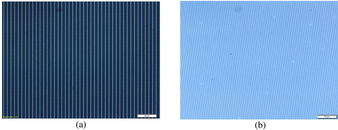
**Figura 4.9** – As imagens ópticas da superfície da amostra 2 após as etapas de processo, sendo (a) após a etapa de corrosão química do Al, para a formação das mesas de Al (faixas em azul claro) sobre a fina camada de  $\text{SiO}_2$  (faixa em azul escuro) e (b) após a etapa de corrosão química do Al, para a formação dos espaçadores de filme de Si-a:H.
