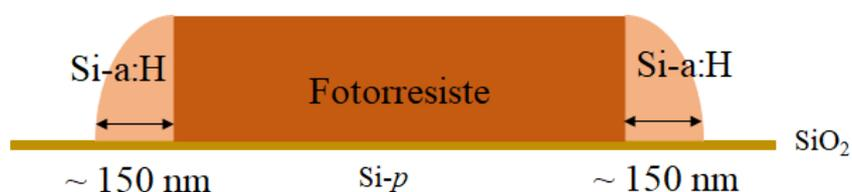
**Figura 3.15** – Desenho esquemático de seção em corte da tecnologia de litografia por espaçador utilizando o fotorresiste como camada sacrificial entre os dois espaçadores de Si-a:H.
