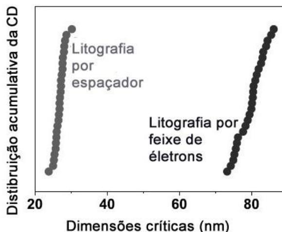
**Figura 1.5** – A comparação da eficiência entre as técnicas SL e EBL na formação das estruturas com dimensões críticas nanométricas (gráfico adaptado, CHOI *et al.*, 2003).
