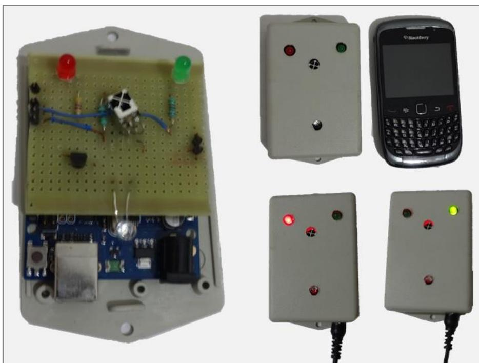
Figura 24. Protótipo inicial do receptor e transmissor de sinais infravermelhos para o aparelho cassete de ar condicionado - elaborado para testes durante a primeira fase de desenvolvimento.
