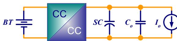
Figura 3.2: Arranjo cascata da conexão ativa da fonte primária.
