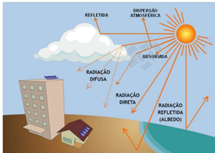
Figura 2.5 Tipos de irradiação solar
