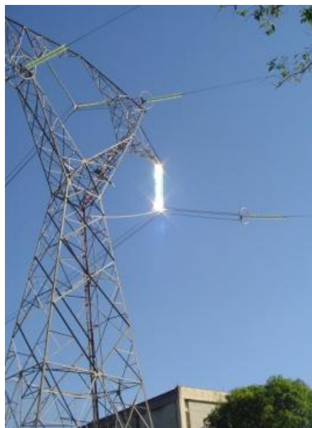
Figura 4.3: Formação de arco em ensaio do CEPEL.
