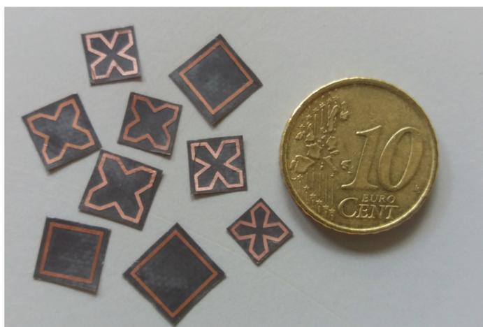
Figura 36 – Algunas de las muestras de resonadores construidas y medidas.
