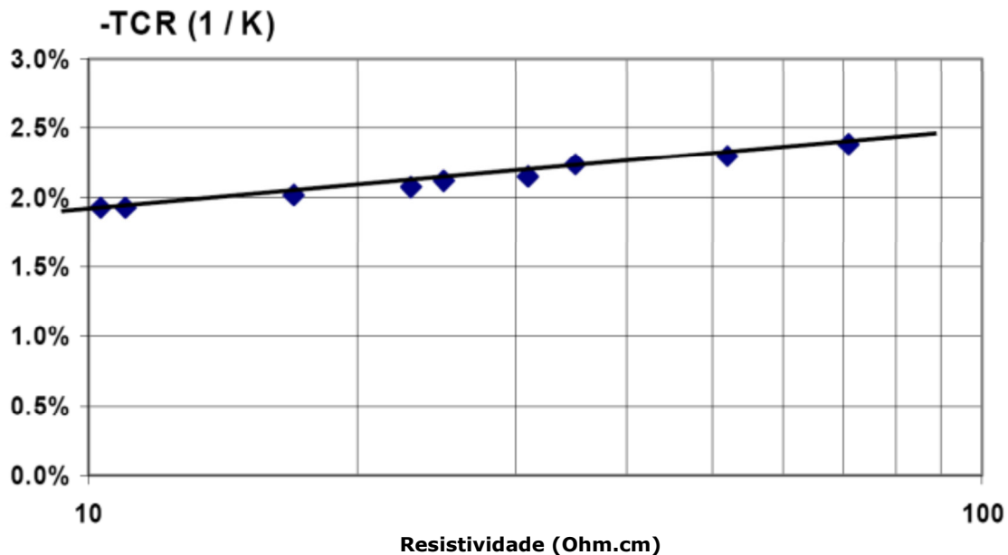
Figura 10 - TCR X Resistividade do filme de a-Si-xGex dopado [61].
