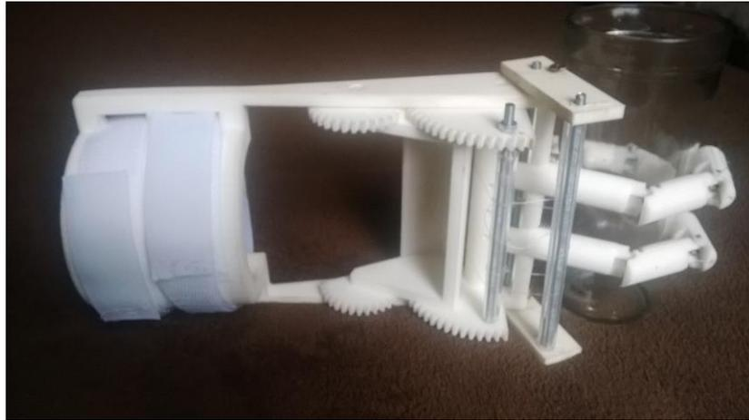
**Figura 2.6** – Mão mecânica de ABS com um êmbolo central aberto e um maciço com molas de torção e tração (Mão mecânica prototipada com auxílio do Instituto Renato Archer)
