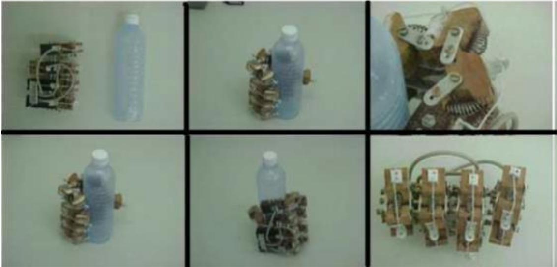
**Figura 2.2** - Mão mecânica de madeira e com molas de extensão nas articulações
