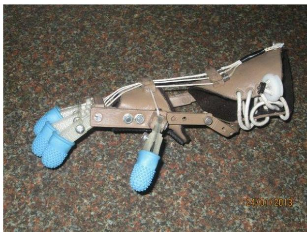
**Figura 1.11** – Prótese para amputados transmetacarpianos implementada com impressora 3d (VAN AS; OWEN, 2013)
