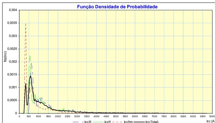
Fig. 3.12 – Função de densidade de probabilidade das correntes de curtos-circuitos sem polarização.
