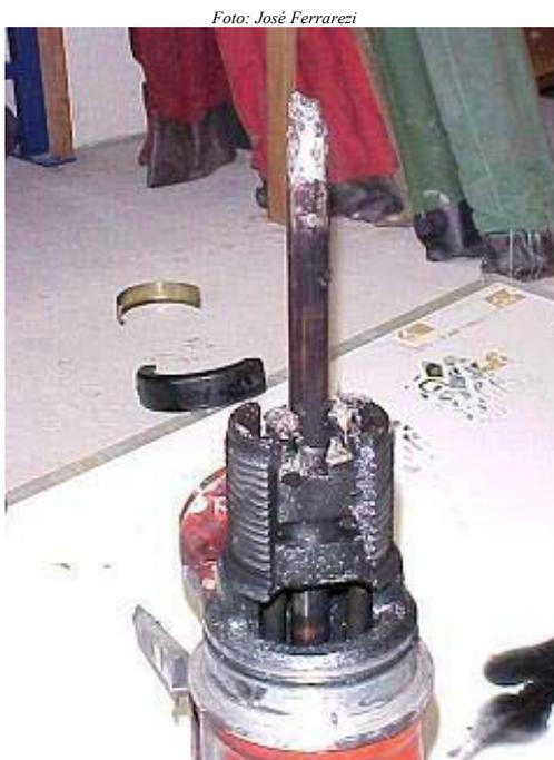
*Fig.1.4 – Pólo de um disjuntor PVO danificado.*
