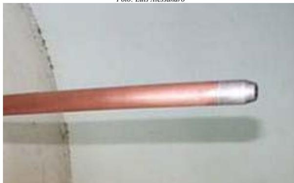
*Fig.1.3 – Haste cilíndrica do pólo de um disjuntor GVO.*
