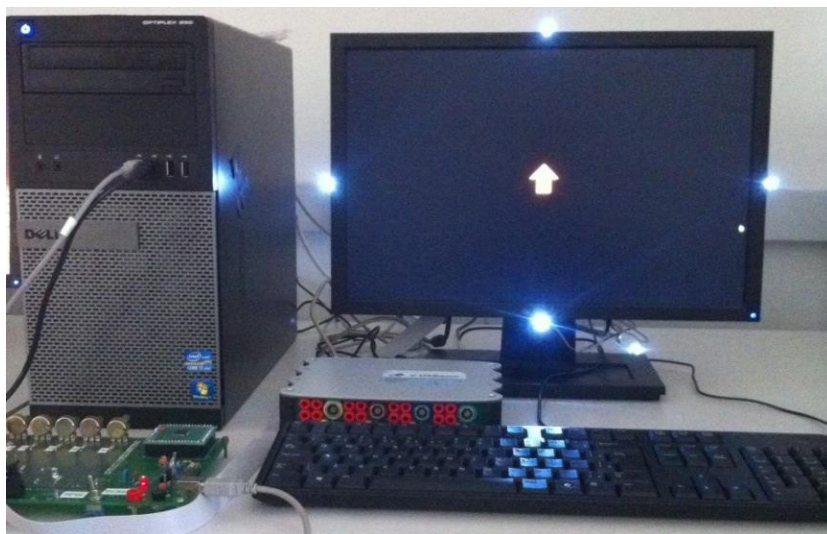
Figura 2.1: Exemplo de interface montada com quatro LEDs para estimulação de SSVEPs. 12
