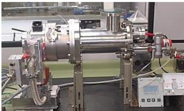
*Figura 3. 13 – Imagem do sistema de plasma, com a câmara de aproximadamente 2 litros, bomba mecânica, bomba turbomolecular, medidor de vácuo e válvula agulha para injeção de gases.*
