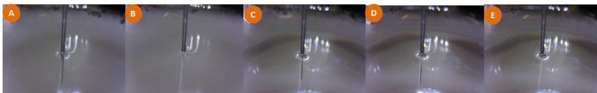
Figura 4. 1 – Gráfico da variação da corrente em função do tempo para a corrosão eletroquímica de um fio de tungstênio e fotos do processo em diferentes tempos.
