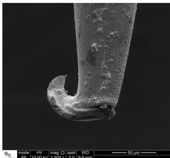
Figura 6. 1 – Imagem de MEV de uma ponta de tungstênio após a ocorrência de centelhamento.
