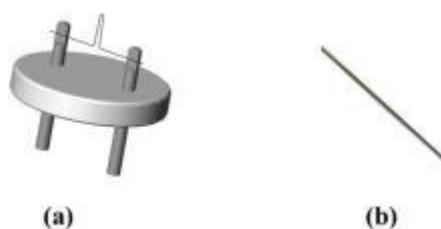
Figura 3. 33 – Ilustrações de um filamento de tungstênio (a) e um fio de tungstênio (b) utilizados para sustentação mecânica dos nanotubos de carbono.
