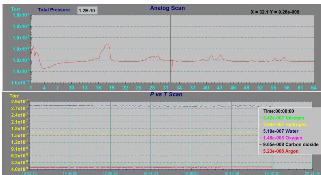
Figura 3. 10 – Imagem do espectro de massa do analisador de gases residuais.
