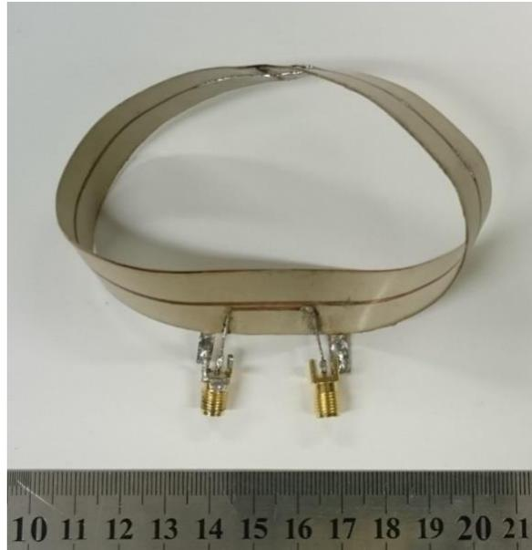
Figura 3.10: A Microstrip B2B Möbius construída.
