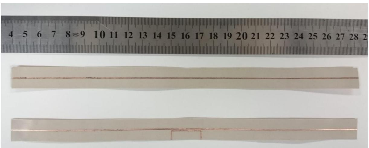
Figura 3.7: As microstrips após a conclusão do ataque químico.
