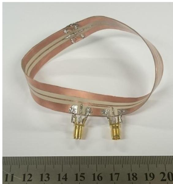
Figura 3.19: A CPW B2B Möbius construído.
