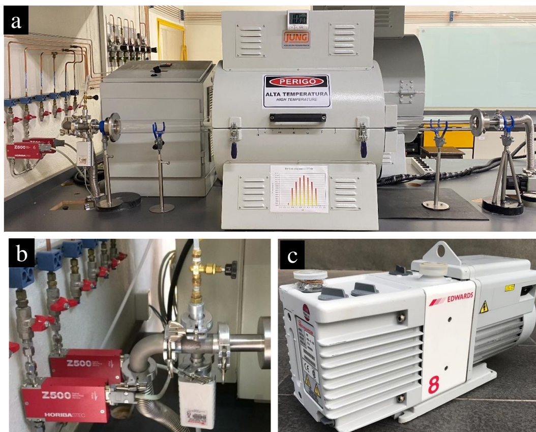
Figura 19: Fotos da estrutura total do forno CVD. a) Estrutura geral. b) Sistema de controle de gases. c) Bomba mecânica de vácuo.
