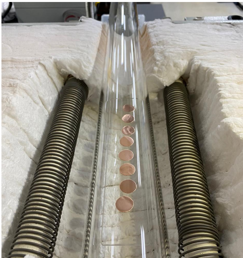
Figura 20: Foto da estrutura de aquecimento do forno e posição das amostras.
