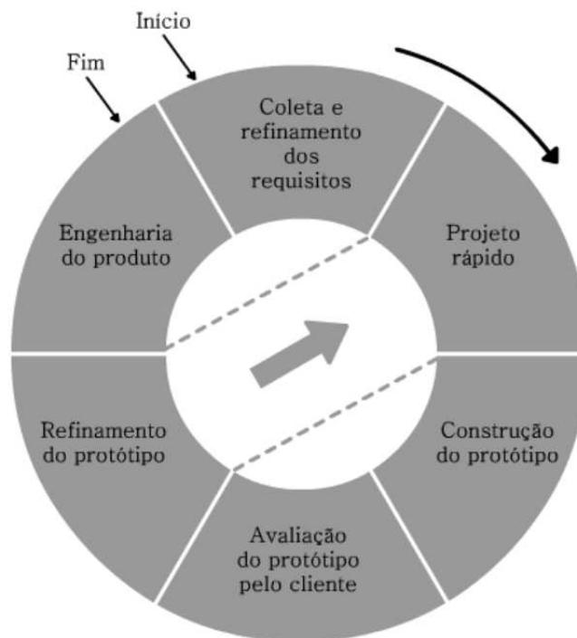
Fig. 2.2: Diagrama das etapas que compõem a metodologia de prototipação. Partindo da coleta e refinamento dos requisitos, um protótipo pode ser trabalhado em múltiplos ciclos até a engenharia do produto. Adaptado de Pressman (2010).
