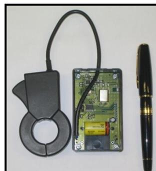
Figura 2.4 – Módulo medidor final
