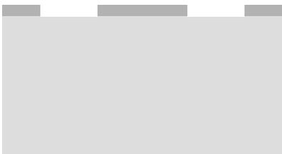
**Figura 2.7- Representação da lâmina de Si-p em corte lateral sem a camada protetora de fotoresista sobre o óxido e as áreas expostas do substrato.**
