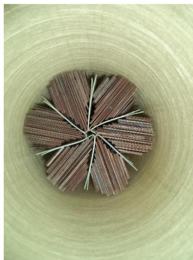
**Figura 6.7:** Encaixe das pernas centrais das janelas do núcleo magnético do LCENS
