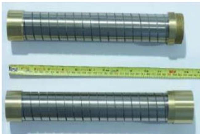
**Figura 3.4: Elementos *bulks* produzidos pela NEXANS [19].**
