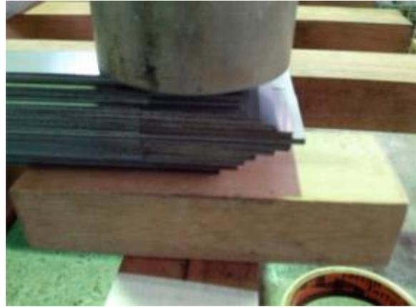
**Figura 6.3: Detalhe do empilhamento das chapas da perna central do núcleo magnético do LCENS**
