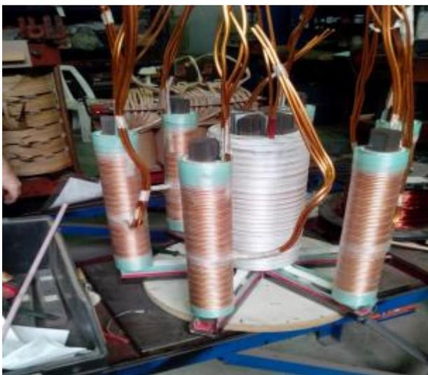
**Figura 6.6:** Bobinas de corrente contínua e alternada encaixadas nas pernas dos núcleos magnéticos
