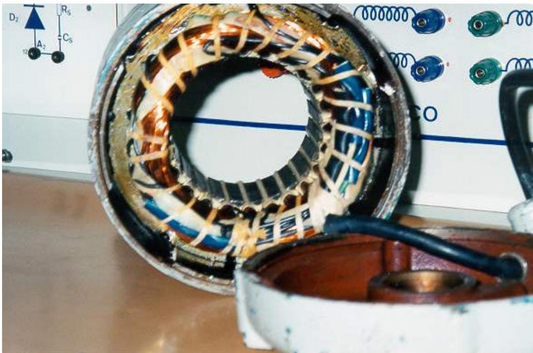
**Figura 7.1: Fotografia do estator**
