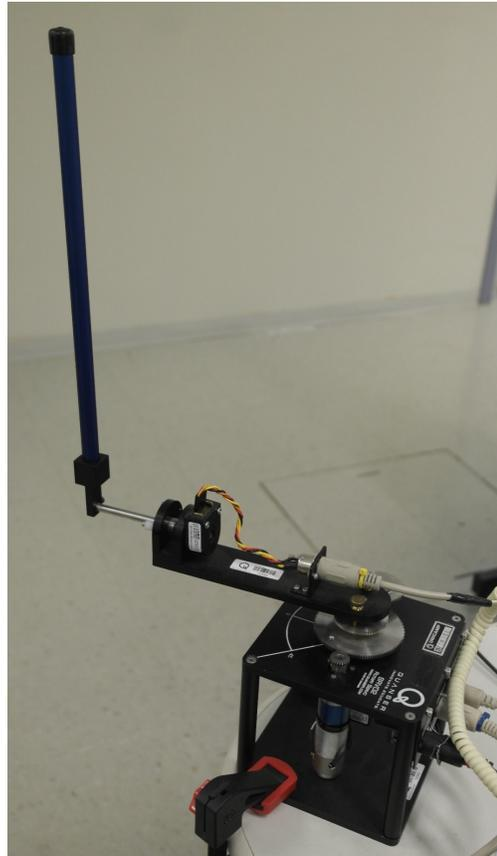
Figura 3 – O pêndulo de Furuta utilizado no projeto.
