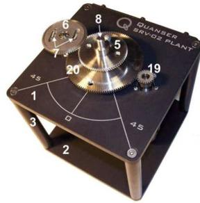
Figura 6 – O sistema mecânico SRV02 do fabricante Quanser em detalhe. Retirado de (APKARIAN *et al.*, 2011). A engrenagem de carga possui o índice (5); a *anti-backslash* (6); a engrenagem acoplada ao eixo (20); e a engrenagem que forma o final da caixa de redução (19).
