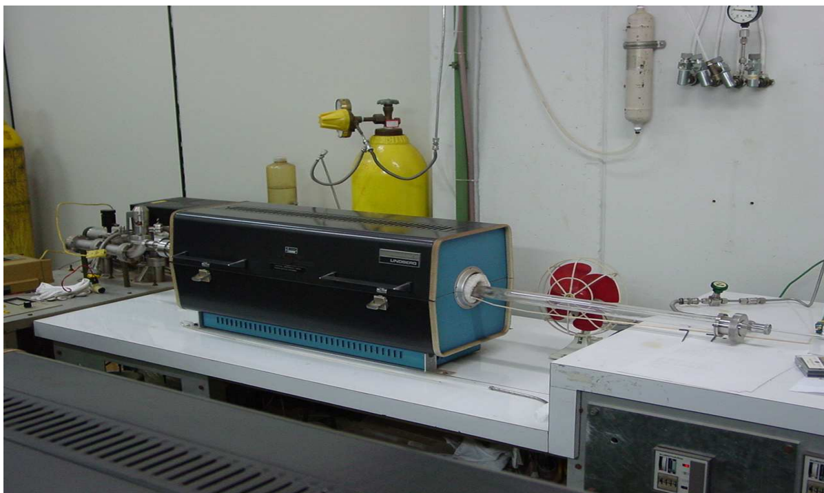
Figura (11) – Mostra a fotografia do sistema CVD.
