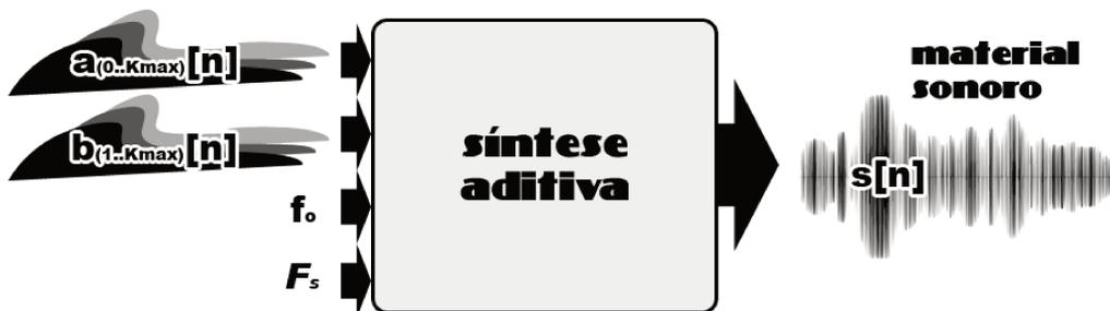
Fig. 2.2: Síntese aditiva: conjunto de  $k_{max}$  osciladores harmônicos da frequência fundamental  $f_0$  modulados pelos arranjos de envelopes  $a_k$  e  $b_k$ . De acordo com a Equação 2.1.
