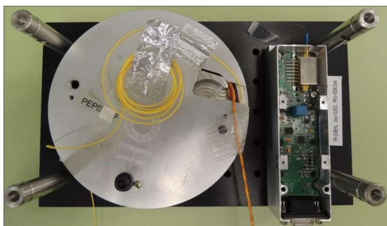
Figura 23 - Módulo óptico, fornecido pela empresa Optsensys, utilizado neste trabalho.
