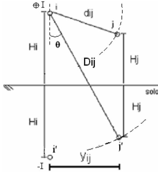
Figura 3.5: Vista transversal dos condutores  $i$  e  $j$ , com suas respectivas imagens  $i'$  e  $j'$ .
