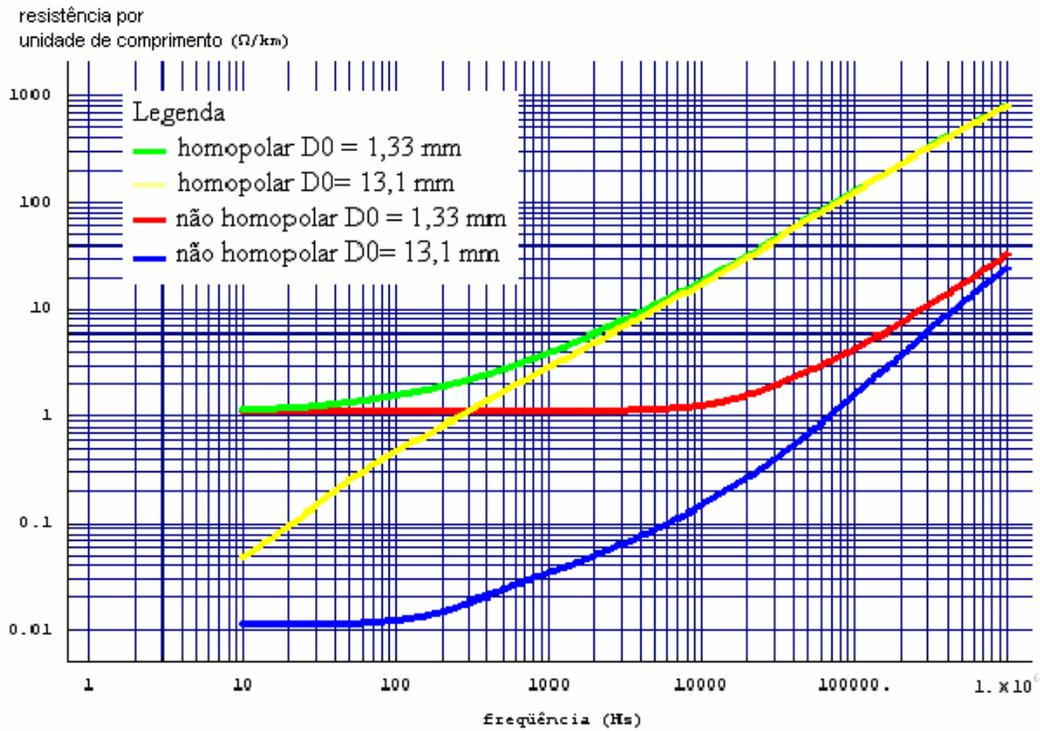
Gráfico 4.17: Resistência nos modos por unidade de comprimento em função da frequência para diferentes diâmetros externo e interno dos condutores de fase e  $k = 2,71$  em função da frequência.
