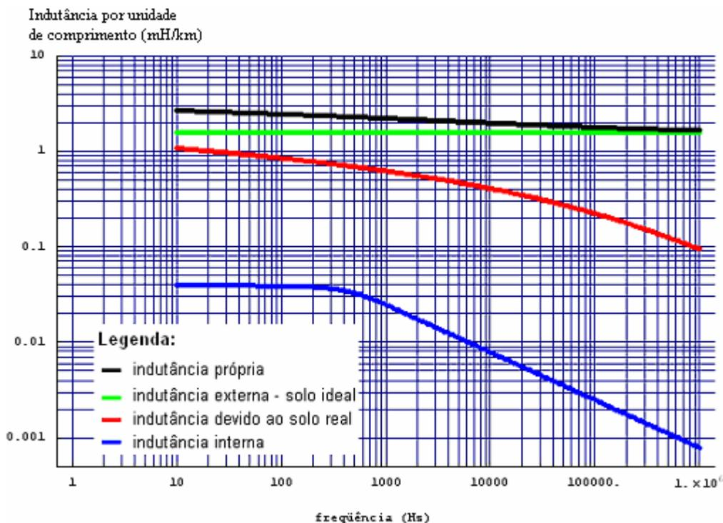
Gráfico 4.3: Indutância total e contribuições por unidade de comprimento referentes ao condutor “a<sub>1</sub>” em função da frequência.
