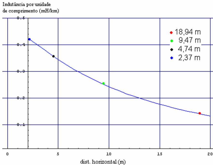
Gráfico 4.36: Indutância mútua externa por unidade de comprimento entre  $a_1$  e  $b_1$  para solo ideal em função da distância horizontal entre as fases.
