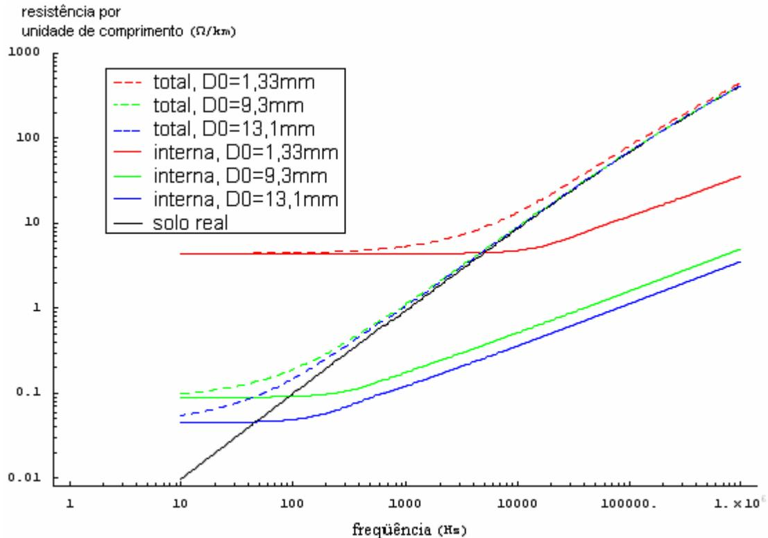
Gráfico 4.14: Resistência total de “a<sub>1</sub>” e parcelas interna e correção de solo real por unidade de comprimento – Diferentes diâmetros externo e interno dos condutores fase mantendo-se  $k = 2,71$ .
