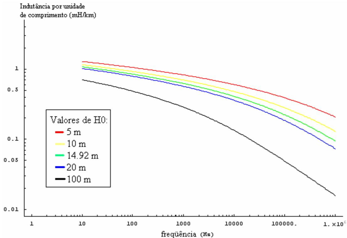
Gráfico 4.27: Parcela da indutância própria de “a<sub>1</sub>” devido ao solo real por unidade de comprimento em função da frequência - Variação da altura dos condutores da linha.
