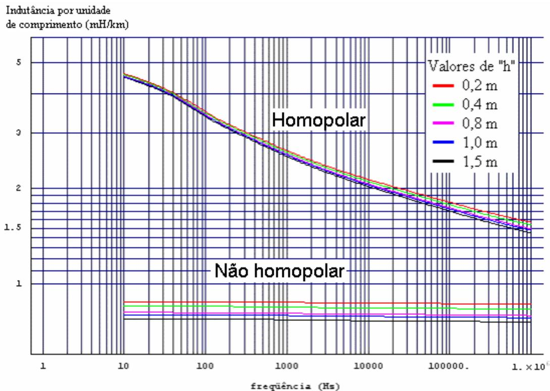
Gráfico 4.43: Indutância nos modos por unidade de comprimento em função da frequência - Variação da altura dos feixes das fases externas.
