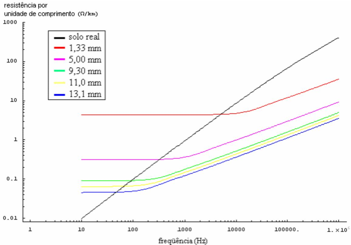
Gráfico 4.13: Resistência interna por unidade de comprimento dos cabos de fase para diferentes diâmetros externos e internos dos condutores de fase e  $k = 2,71$  em função da frequência.
