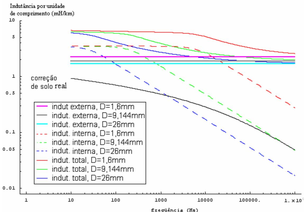
Gráfico 4.10: Indutância total, interna, externa e correção de solo real por unidade de comprimento para cabos pára-raios de diferentes diâmetros em função da frequência. Comparação com a indutância devida à correção de solo real.
