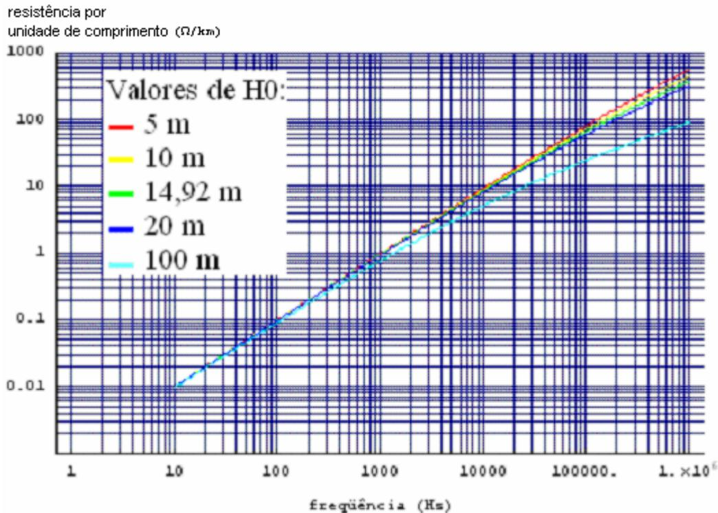
Gráfico 4.24: Parcela da resistência mútua entre  $b_1$  e  $a_1$  devido à correção de solo real por unidade de comprimento em função da frequência - Variação da altura dos condutores da linha.
