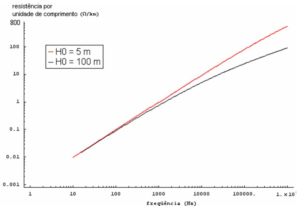
Gráfico 4.26: Resistência total mútua de “a<sub>1</sub>” e “b<sub>1</sub>” por unidade de comprimento - Variação da altura dos condutores da linha.
