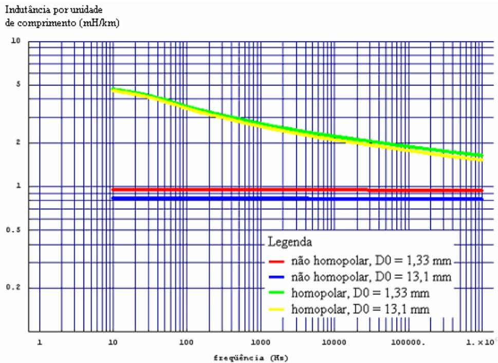
Gráfico 4.18: Indutância nos modos por unidade de comprimento em função da frequência para diferentes diâmetros externo e interno dos condutores de fase e  $k = 2,71$  em função da frequência.
