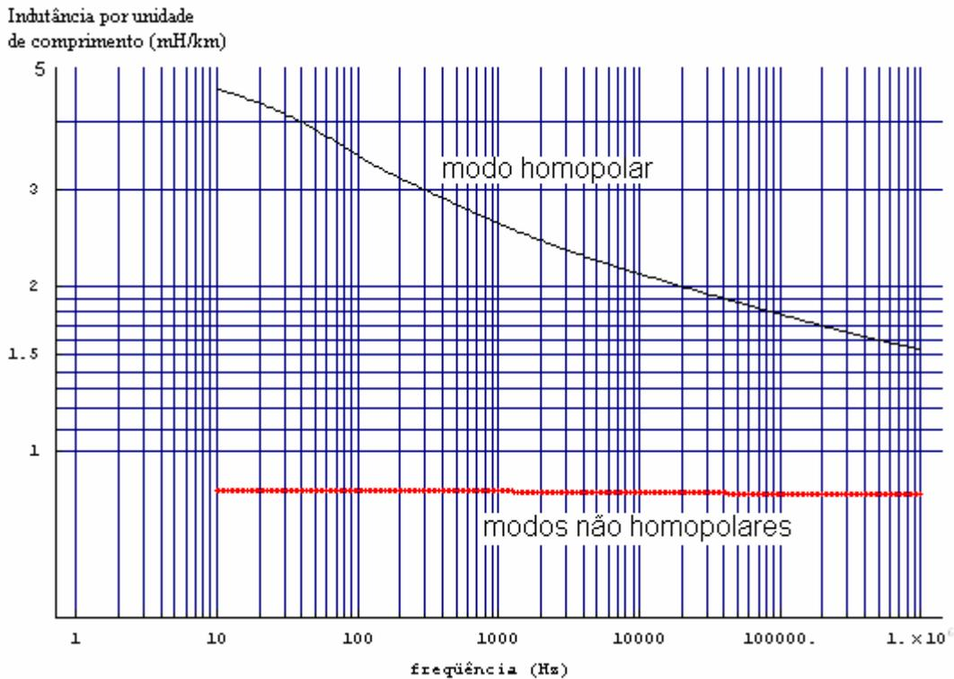
Gráfico 4.7: Indutância por unidade de comprimento em função da frequência no domínio dos modos.
