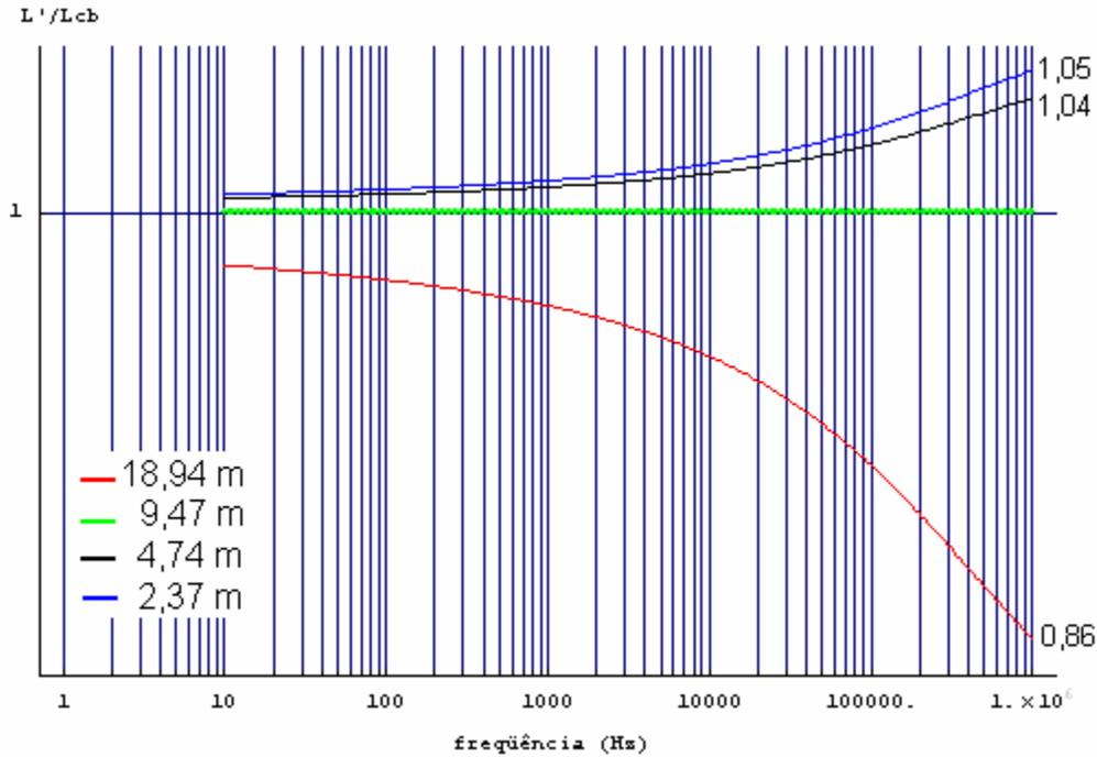
Gráfico 4.35: Efeito do solo na indutância mútua por unidade de comprimento em relação ao caso base entre os condutores  $b_1$  e  $a_1$  em função da frequência - Variação da distância horizontal das fases externas.
