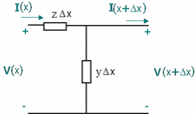
Figura 3.3: Trecho do comprimento  $\Delta x$  da linha no domínio da frequência.
