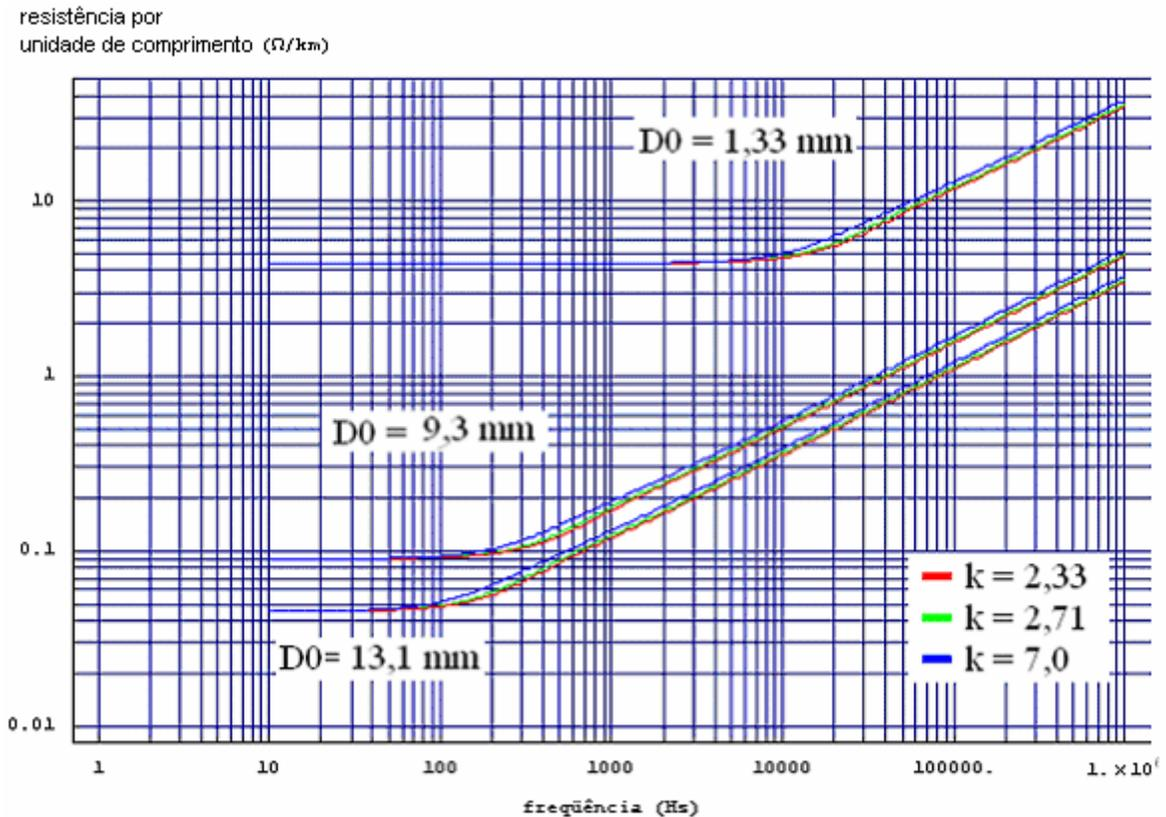
Gráfico 4.19: Resistência interna por unidade de comprimento em função da frequência – Variação de  $k$  para diferentes valores de diâmetro interno.
