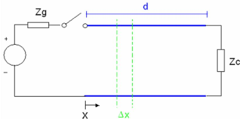
Figura 3.1: Esquema de linha monofásica conectando a fonte à carga.
