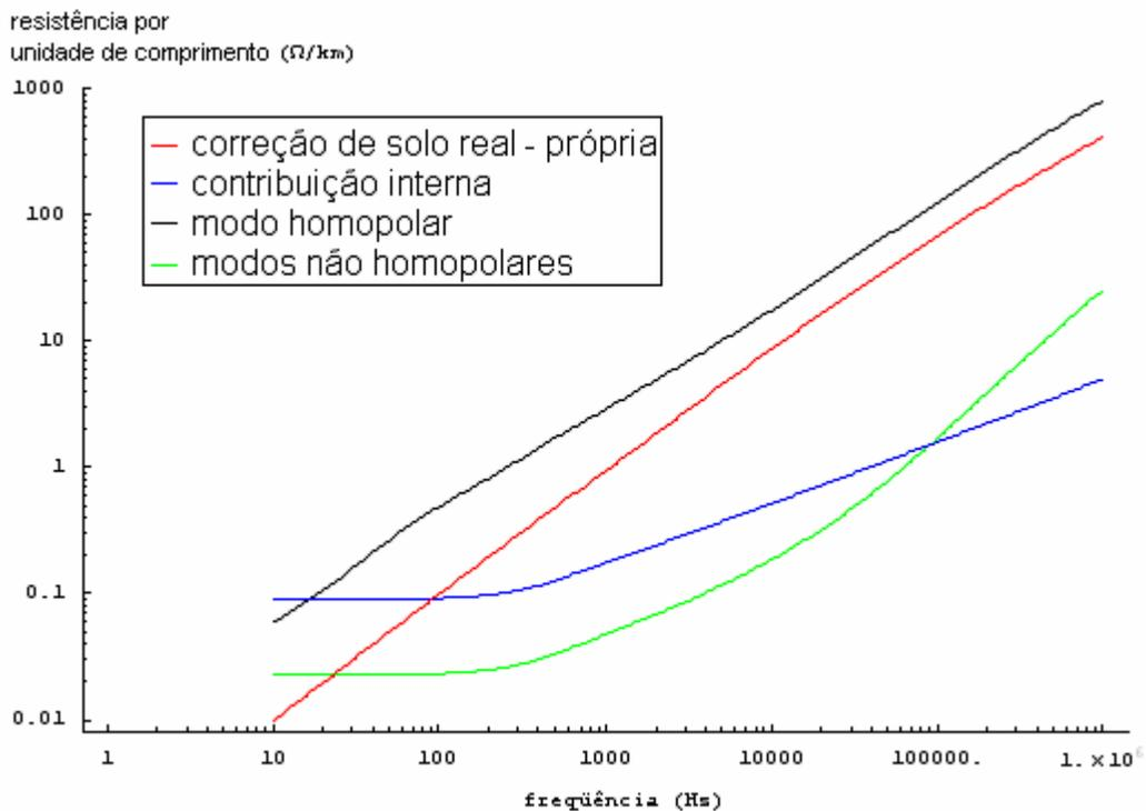
Gráfico 4.6: Contribuições próprias da resistência de “a<sub>1</sub>” e resistências nos modos por unidade de comprimento.
