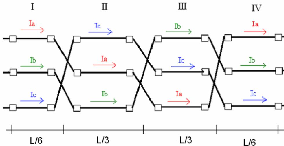
Figura 3.8: Esquema de transposição de linha de transmissão trifásicas circuito simples com quatro trechos.
