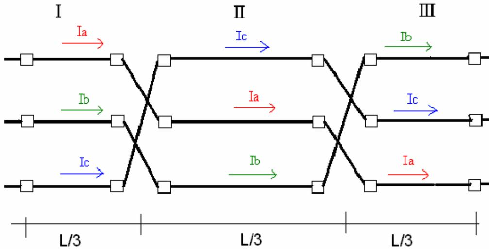
Figura 3.7: Esquema de transposição de linha de transmissão trifásicas de circuito simples com três trechos.
