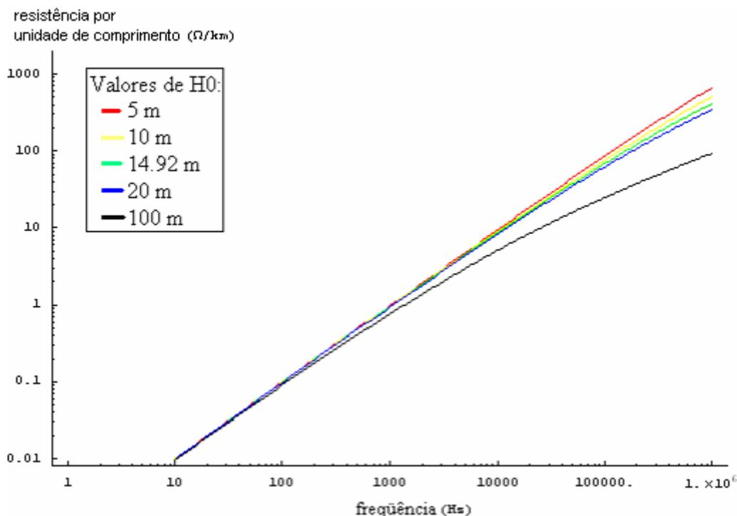
Gráfico 4.23: Parcela da resistência de “a<sub>1</sub>” devido à correção de solo real por unidade de comprimento em função da frequência – Variação da altura dos condutores da linha.
