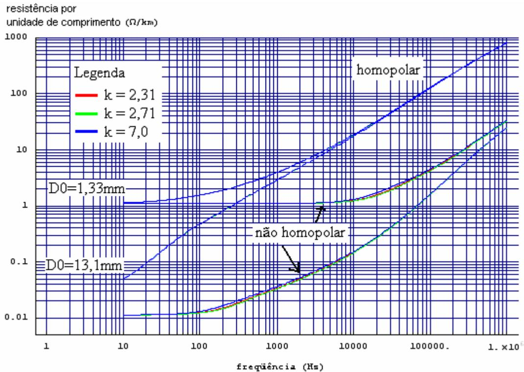
Gráfico 4.21: Resistência nos modos por unidade de comprimento em função da frequência - Variação de  $k$  para diferentes valores de diâmetro interno dos condutores de fase.
