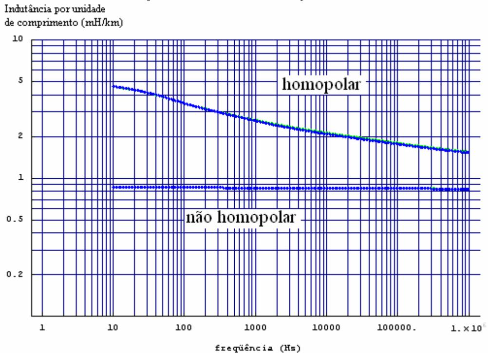
Gráfico 4.12: Indutância nos modos por unidade de comprimento em função da frequência – Variação do diâmetro dos cabos pára-raios.
