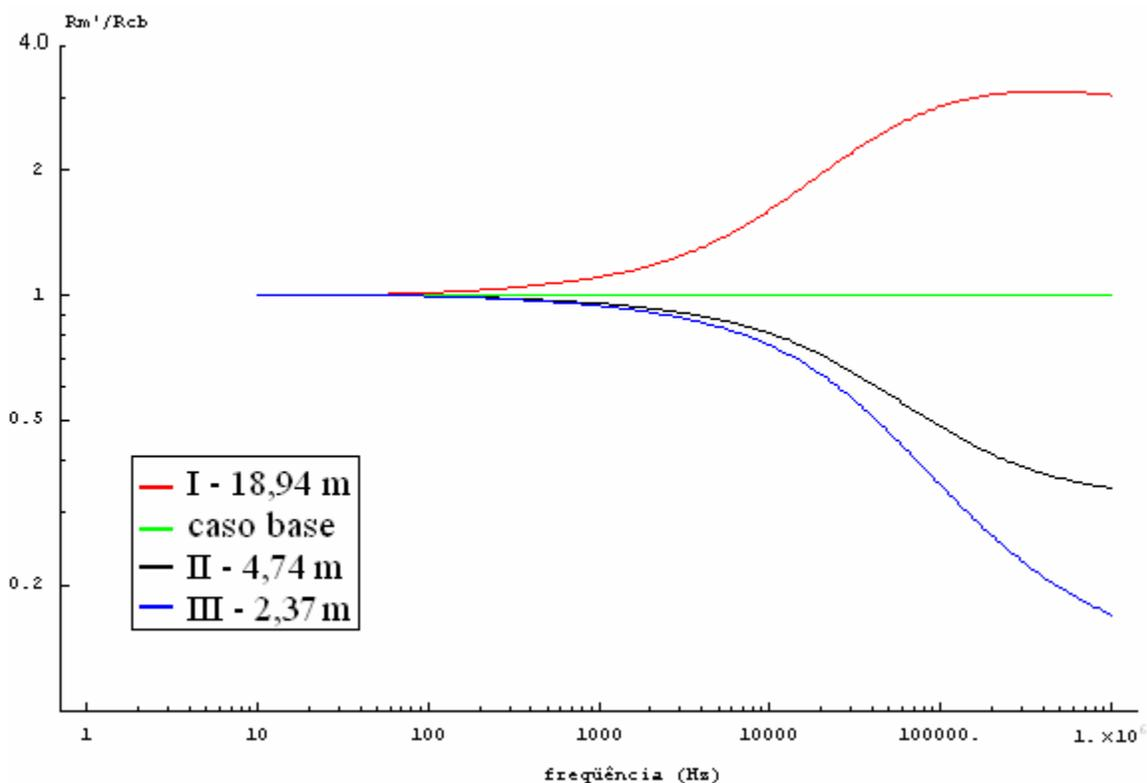
Gráfico 4.38: Resistência não homopolar em relação ao caso base em função da frequência -
