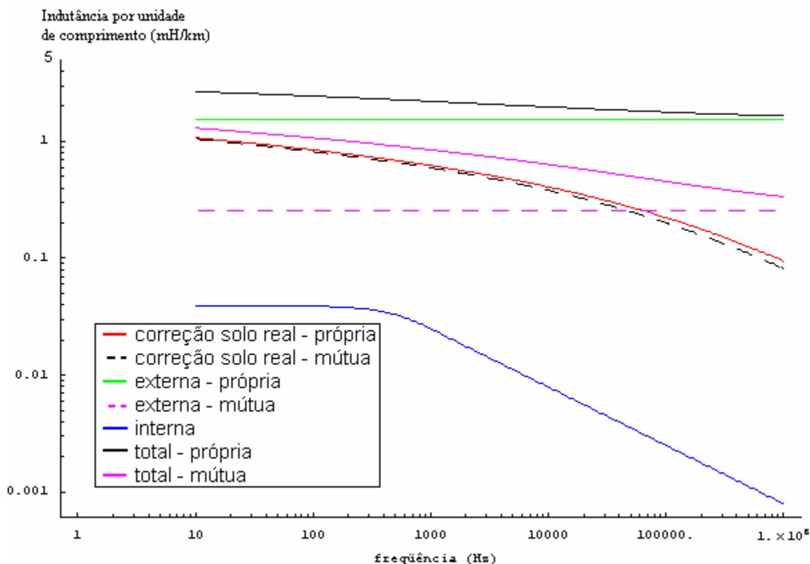
Gráfico 4.4: Indutâncias total, externa e de correção de solo real mútuas entre “a<sub>1</sub>” e “b<sub>1</sub>”; total, externa, correção de solo real e interna de “a<sub>1</sub>” por unidade de comprimento em função da frequência.
