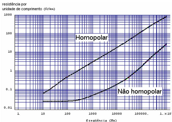
Gráfico 4.42: Resistência nos modos por unidade de comprimento em função da frequência - Variação da altura dos feixes das fases externas.
