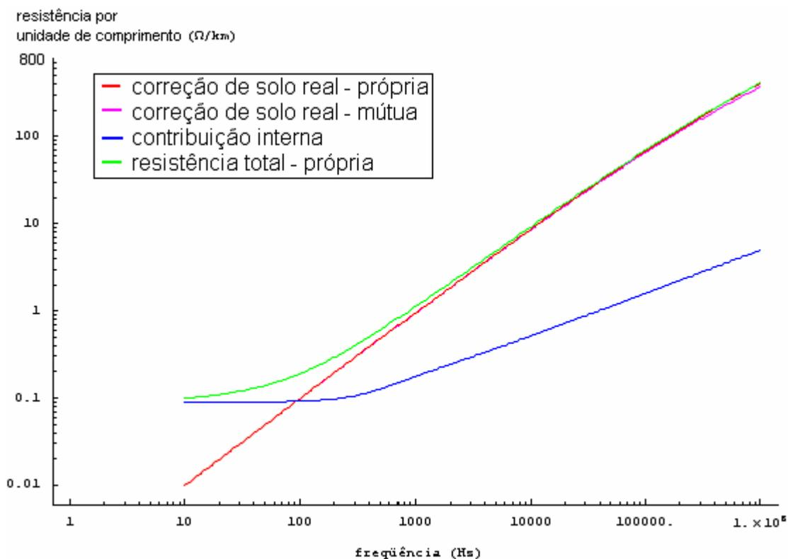
Gráfico 4.2: Resistências mútuas entre  $a_1$  e  $b_1$  devido a correção de solo real, própria de  $a_1$  para solo real, interna de  $a_1$  e total própria de  $a_1$  por unidade de comprimento em função da frequência.
