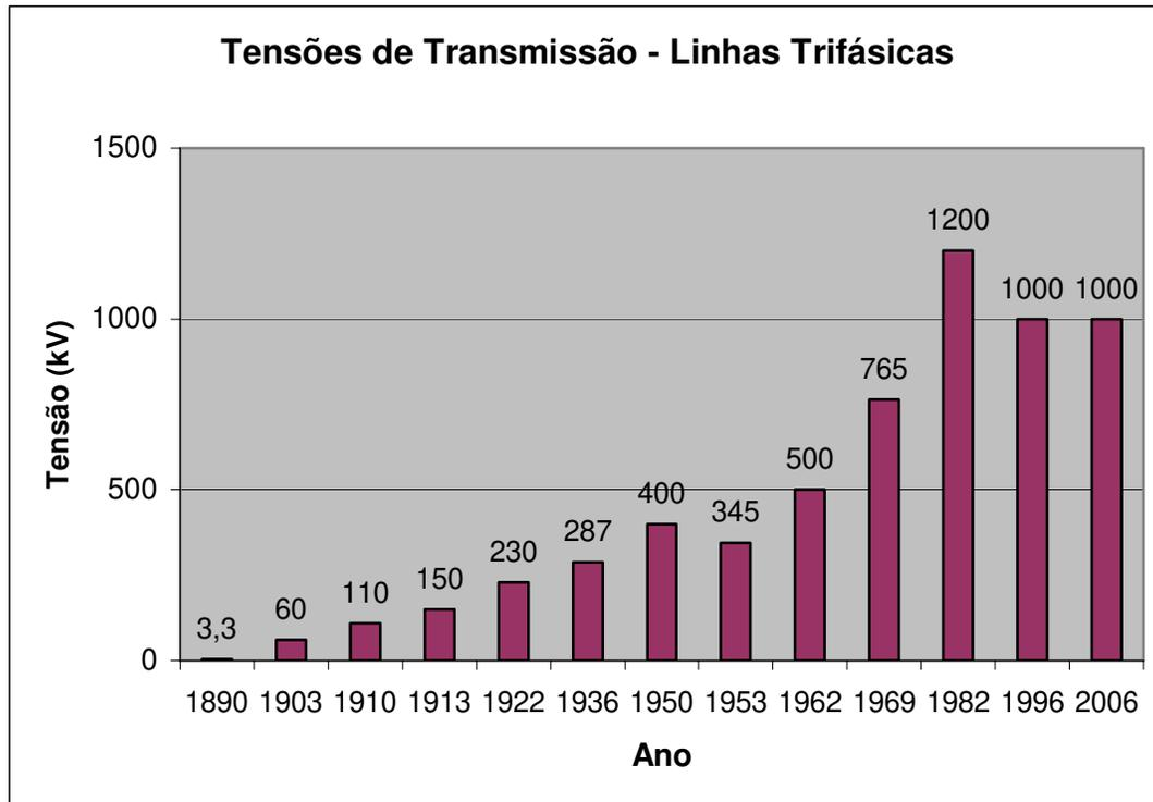
Figura 1.1: Evolução dos níveis de tensão nas linhas de transmissão trifásicas.
