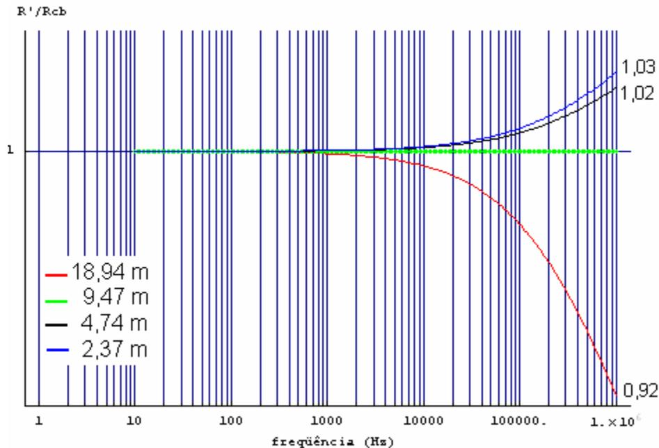
Gráfico 4.34: Efeito do solo na resistência mútua por unidade de comprimento em relação ao caso base entre os condutores  $a_1$  e  $b_1$  em função da frequência - Variação da distância horizontal das fases externas.
