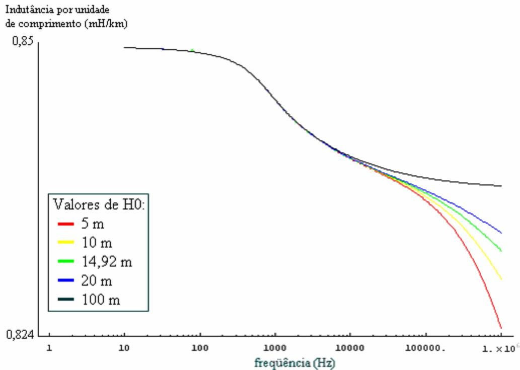
Gráfico 4.32: Indutância não homopolar por unidade de comprimento em função da frequência - Variação da altura dos condutores da linha.
