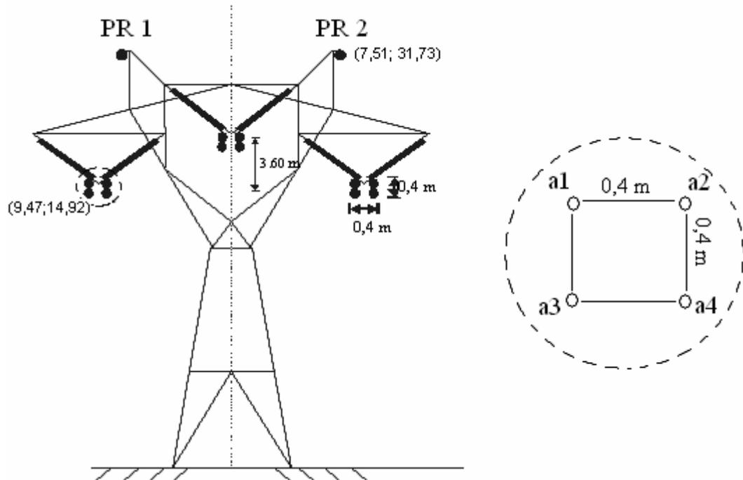
Figura 4.1: Silhueta esquemática de torre da linha de transmissão de 440 kV da CESP de Araraquara a Bauru.
