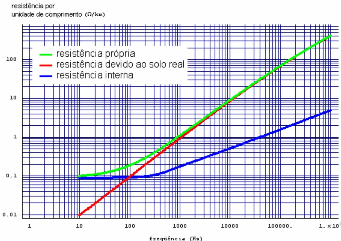
Gráfico 4.1: Resistência total e parcelas por unidade de comprimento referentes ao condutor “a<sub>1</sub>” em função da frequência.
