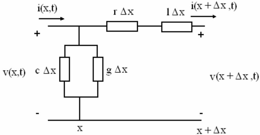
Figura 3.2: Trecho de linha de comprimento  $\Delta x$ .
