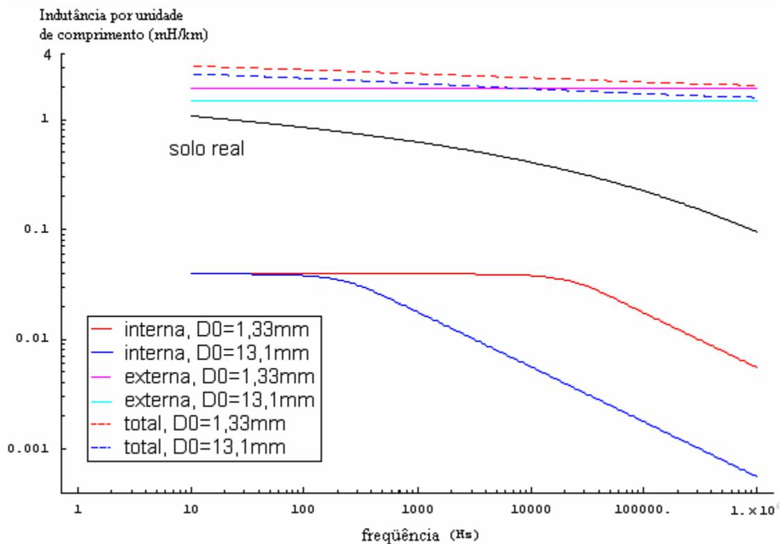
Gráfico 4.16: Indutância total de “a<sub>1</sub>” e suas parcelas por unidade de comprimento para diferentes diâmetros externos e internos dos condutores de fase e  $k = 2,71$  em função da frequência.
