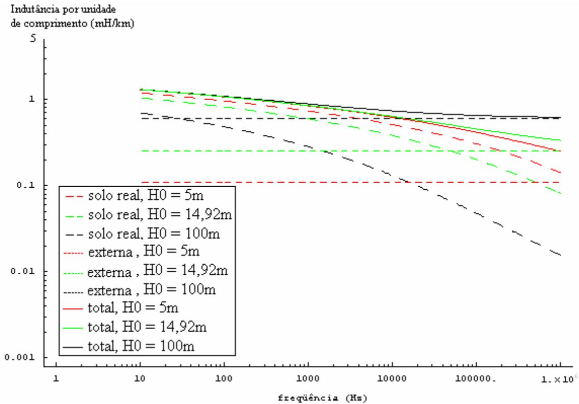
Gráfico 4.30: Indutância total mútua entre “a<sub>1</sub>” e “b<sub>1</sub>” e suas parcelas por unidade de comprimento em função da frequência - Variação da altura dos condutores da linha.
