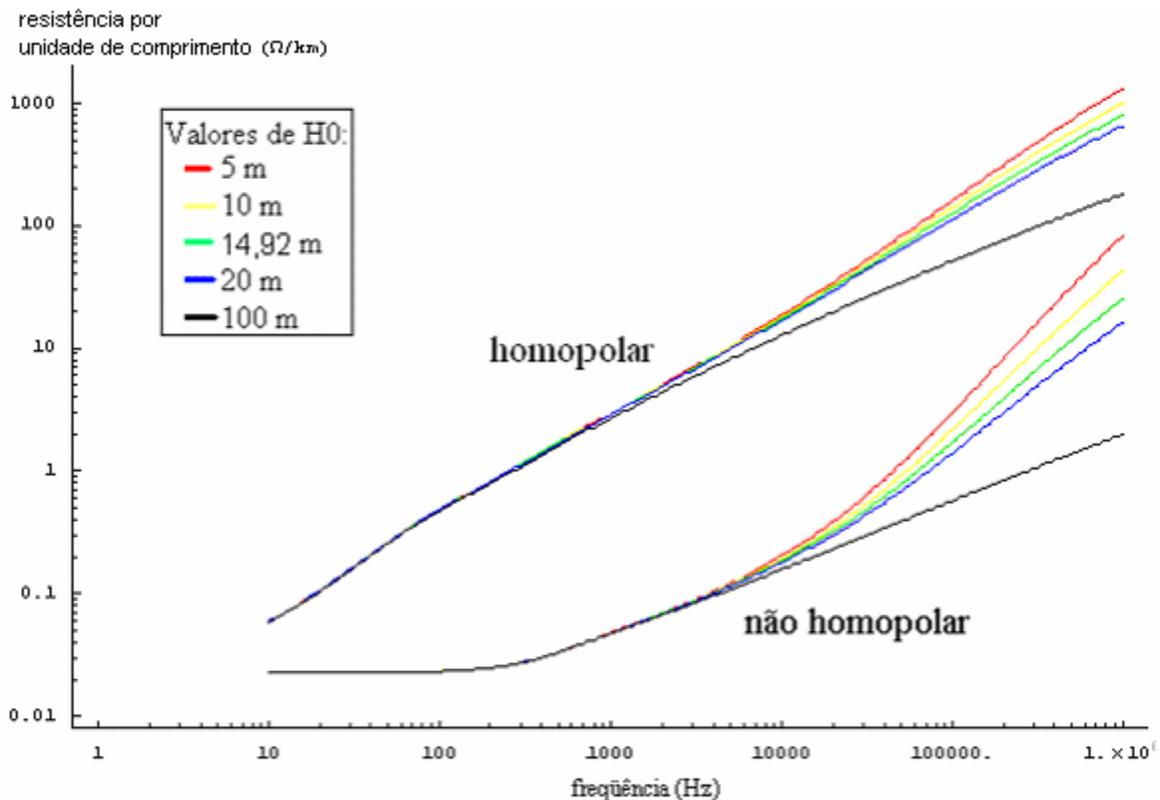
Gráfico 4.31: Resistência nos modos por unidade de comprimento em função da frequência
