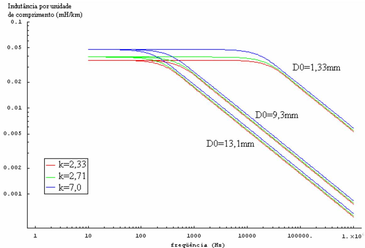
Gráfico 4.20: Indutância interna por unidade de comprimento de “ $a_1$ ” na frequência - Variação de  $k$  para diferentes valores de diâmetro interno.
