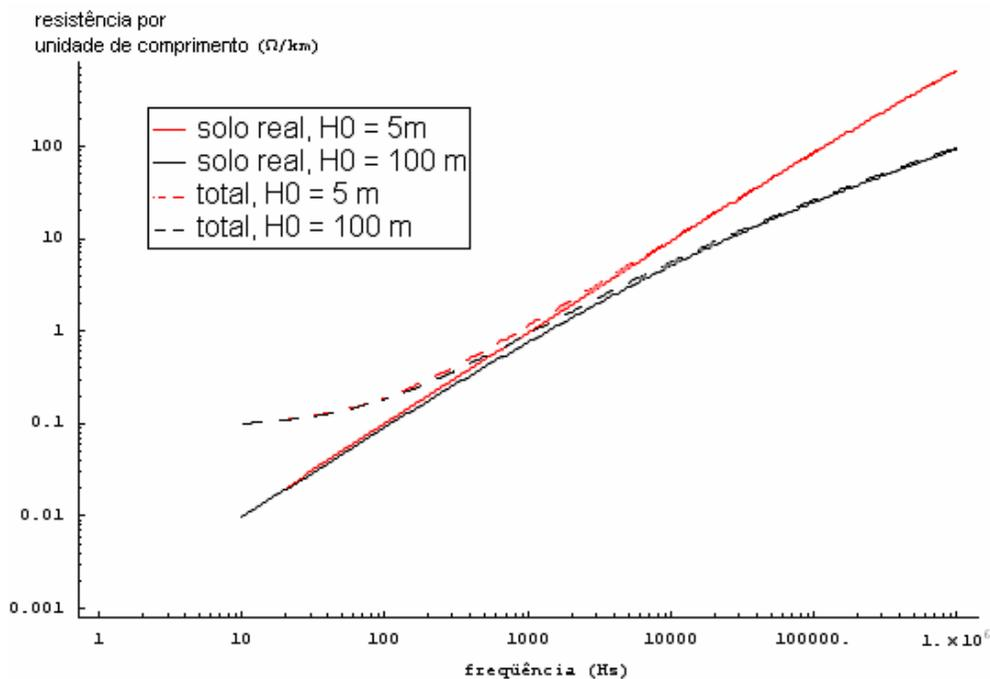
Gráfico 4.25: Resistência total própria de “a<sub>1</sub>” e parcela relativa à correção para solo real por unidade de comprimento - Variação da altura dos condutores da linha.
