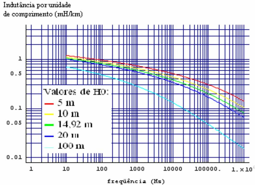
Gráfico 4.28: Parcela da indutância mútua entre  $a_1$  e  $b_1$  por unidade de comprimento devido ao solo real em função da frequência - Variação da altura dos condutores da linha.
