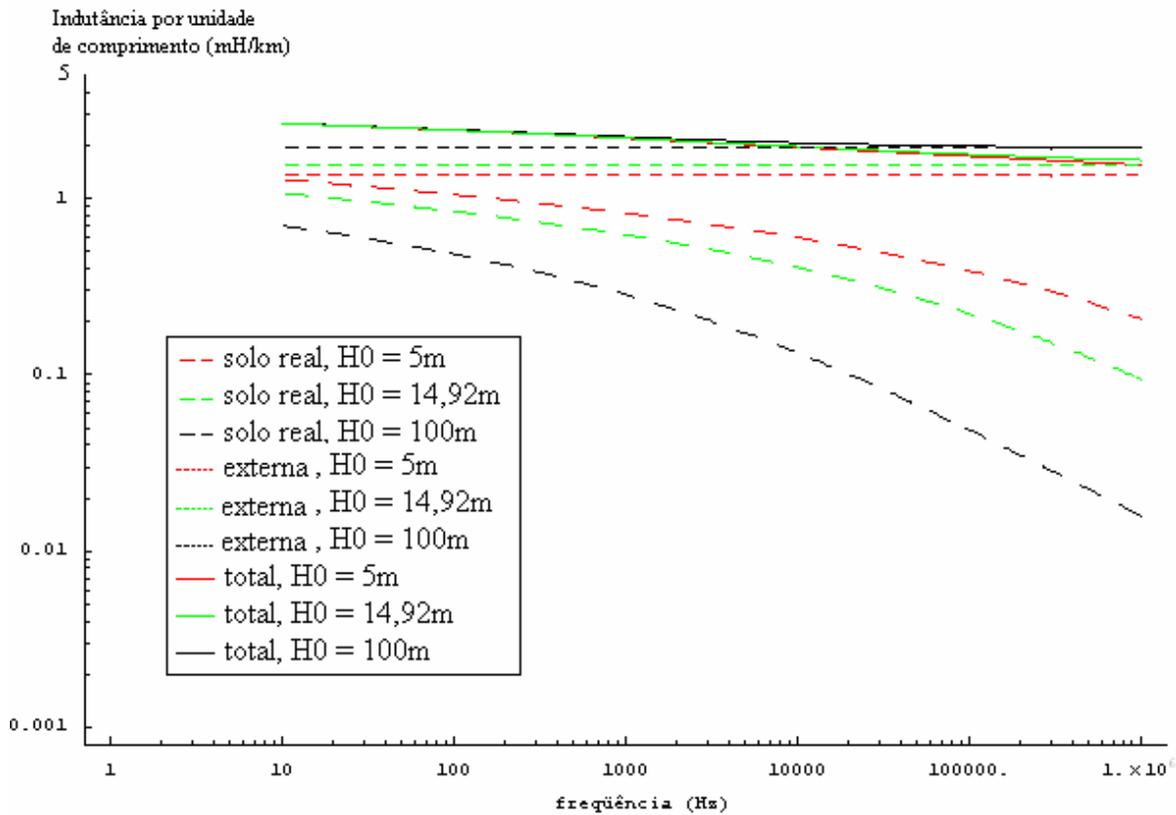
Gráfico 4.29: Indutância total do condutor “ $a_1$ ” e suas parcelas por unidade de comprimento em função da frequência - Variação da altura dos condutores da linha.
