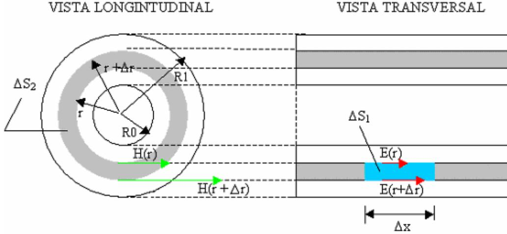
Figura 3.4: Vistas longitudinal e transversal de um condutor cilíndrico de seção reta em forma de coroa circular.
