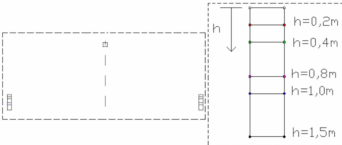
Figura 4.3: Posição dos condutores fase para diferentes valores de “h”, com destaque para o feixe das fases externas.
