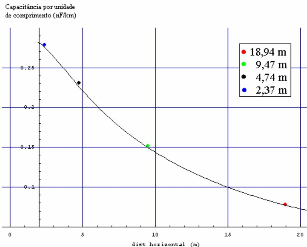
Gráfico 4.37: Capacitância mútua por unidade de comprimento externa entre  $a_1$  e  $b_1$  para solo ideal em função da distância entre as fases.
