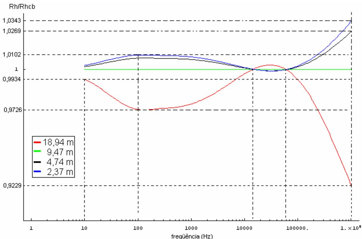
Gráfico 4.39: Resistência homopolar em relação ao caso base em função da frequência - Variação da distância horizontal das fases externas.
