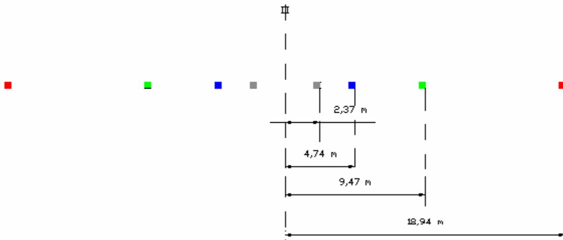
Figura 4.2: Posição dos condutores fase na torre para os diferentes casos, com variação da localização das fases externas, conservando fixa a fase central.
