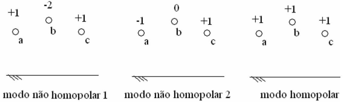
Figura 3.9: Correntes nos condutores, para as componentes de Clarke.
