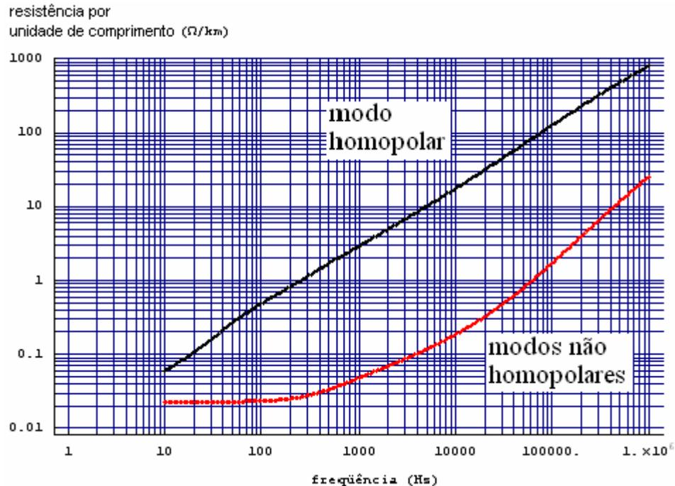
Gráfico 4.5: Resistência por unidade de comprimento em função da frequência no domínio dos modos.
