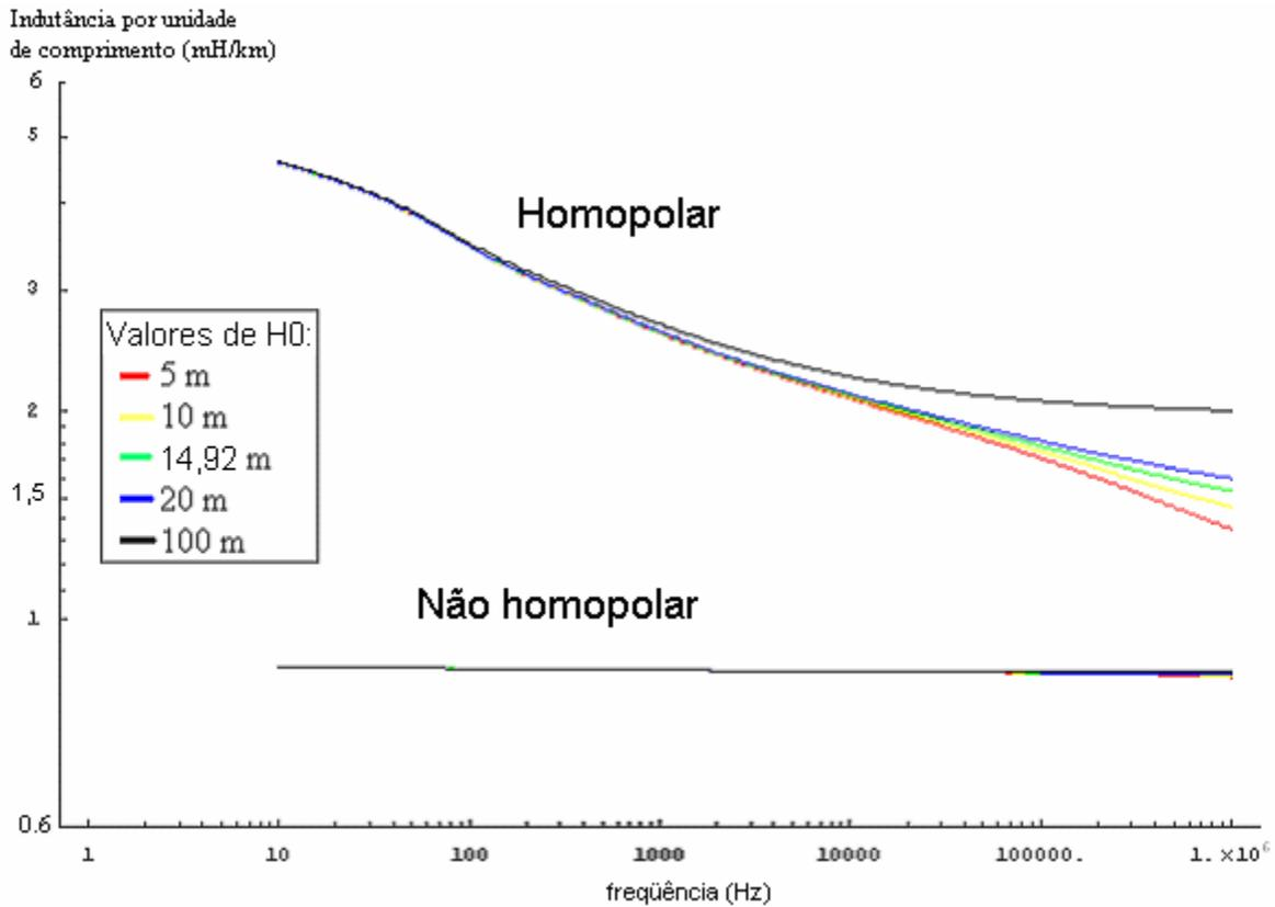
Gráfico 4.33: Indutância nos modos por unidade de comprimento em função da frequência - Variação da altura dos condutores da linha.
