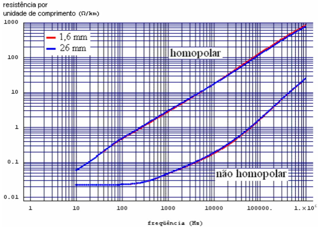
Gráfico 4.11: Resistência por unidade de comprimento nos modos em função da frequência – Variação do diâmetro dos cabos pára-raios.
