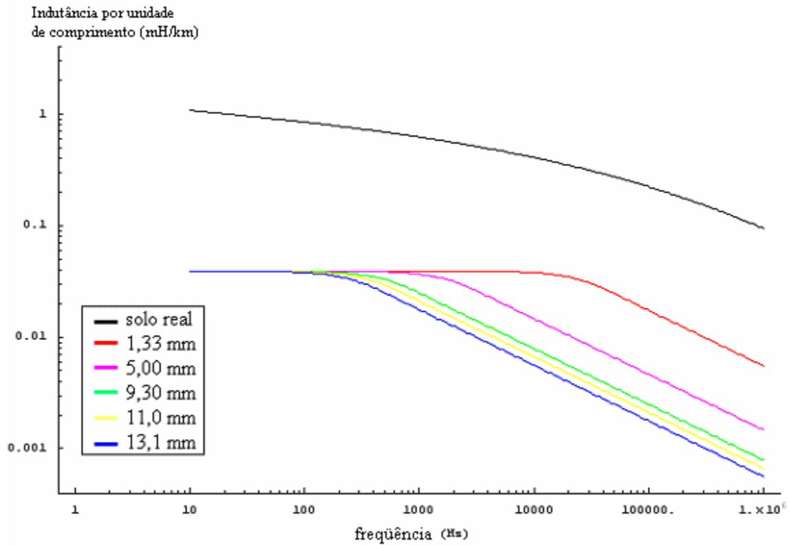
Gráfico 4.15: Indutância interna por unidade de comprimento dos condutores de fase para diferentes diâmetros externos e internos dos condutores de fase e  $k = 2,71$  em função da frequência. Comparação com a indutância devido à correção de solo real por unidade de comprimento.
