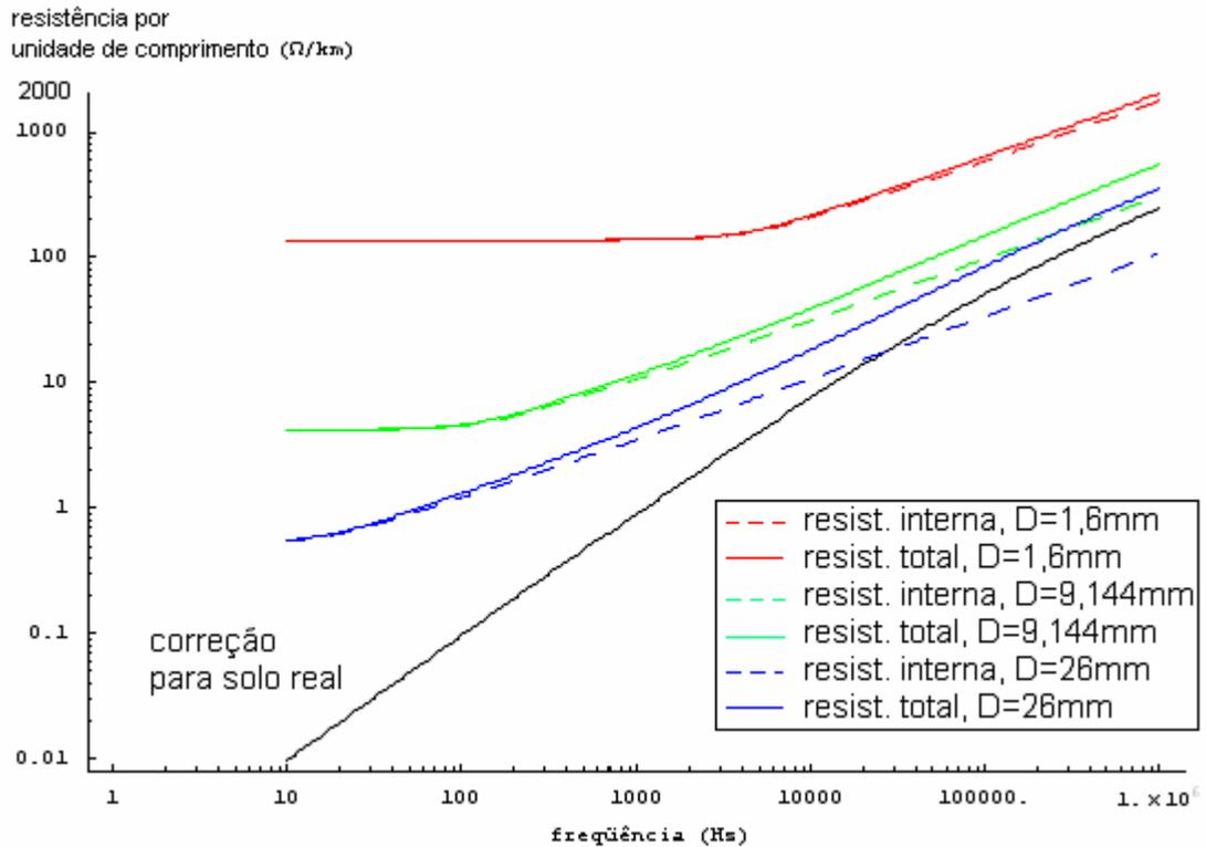
Gráfico 4.9: Resistência total, interna e correção de solo real por unidade de comprimento de cabo pára-raio de diferentes diâmetros em função da frequência. Comparação com a resistência devido à correção de solo real.
