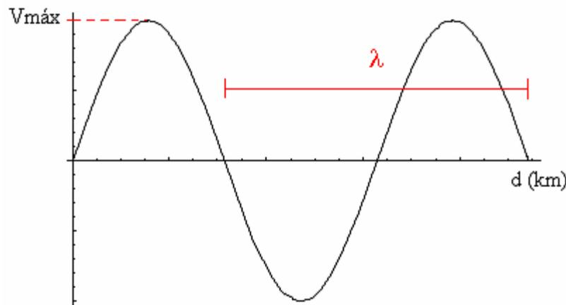
Gráfico 3.1: Perfil de tensão ao longo de uma linha para tempo fixo com atenuação nula – Visualização do comprimento de onda.
