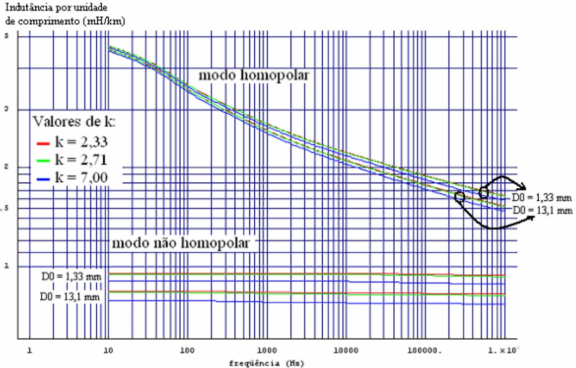
Gráfico 4.22: Indutância nos modos por unidade de comprimento em função da frequência - Variação de  $k$  para diferentes valores de diâmetro interno.
