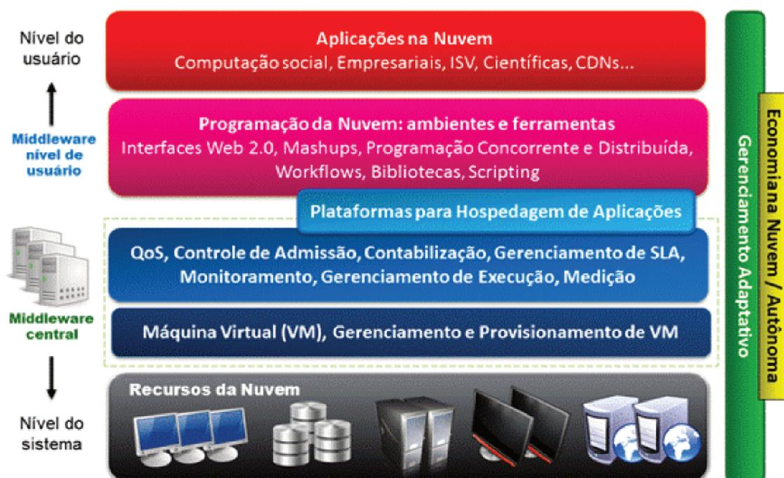
Figura 9 – Arquitetura da computação em nuvem (FONTE: (VECCHIOLA *et al.*, 2009 apud SOUSA *et al.*, 2009).)
