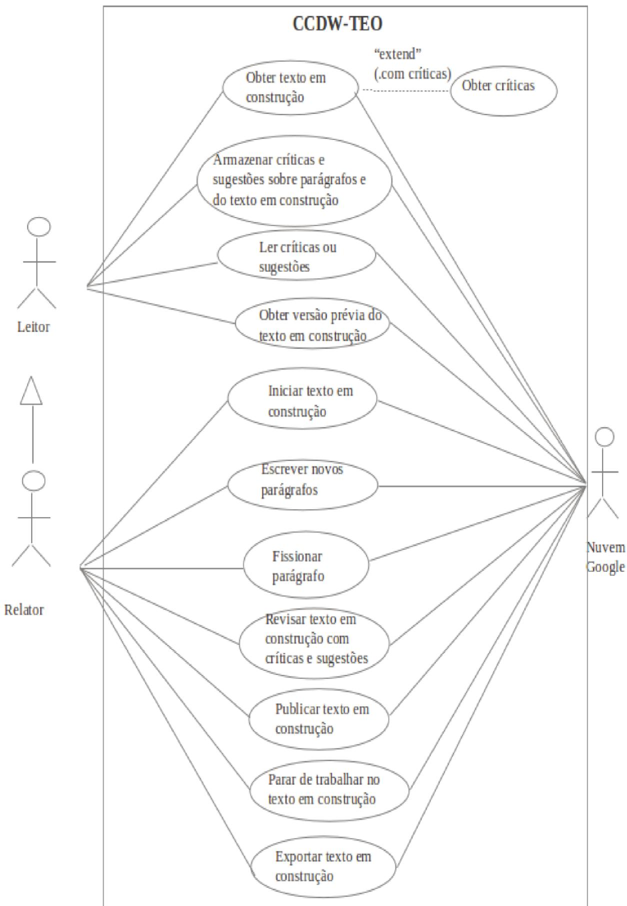
Figura 5 – Diagrama de Caso de Uso (UML) de CCDW-TEO. (Fonte: elaborada pelos autores).
