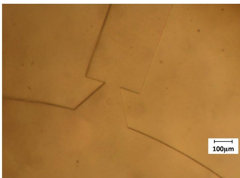
Figura 11-6 - Válvula bico difusor para bombeamento de fluidos em microcanais.
