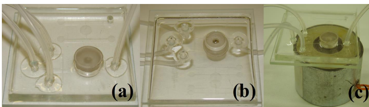
Figura 11-5 - Imagens do misturador fabricado: (a) visto de cima, (b) visto de baixo e (c) em conjunto com eletroímã.
