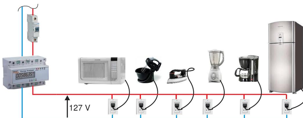
**Figura 14.** Circuito elétrico residencial monitorado por um medidor inteligente.
