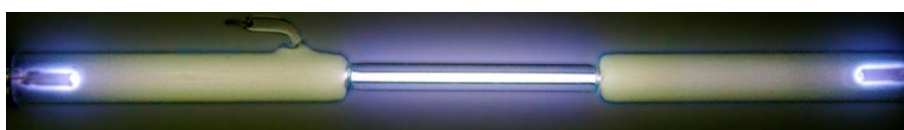
Figura 21 - Descarga elétrica em uma lâmpada de oxigênio. Fonte: (Wikimedia Commons, 2019).
