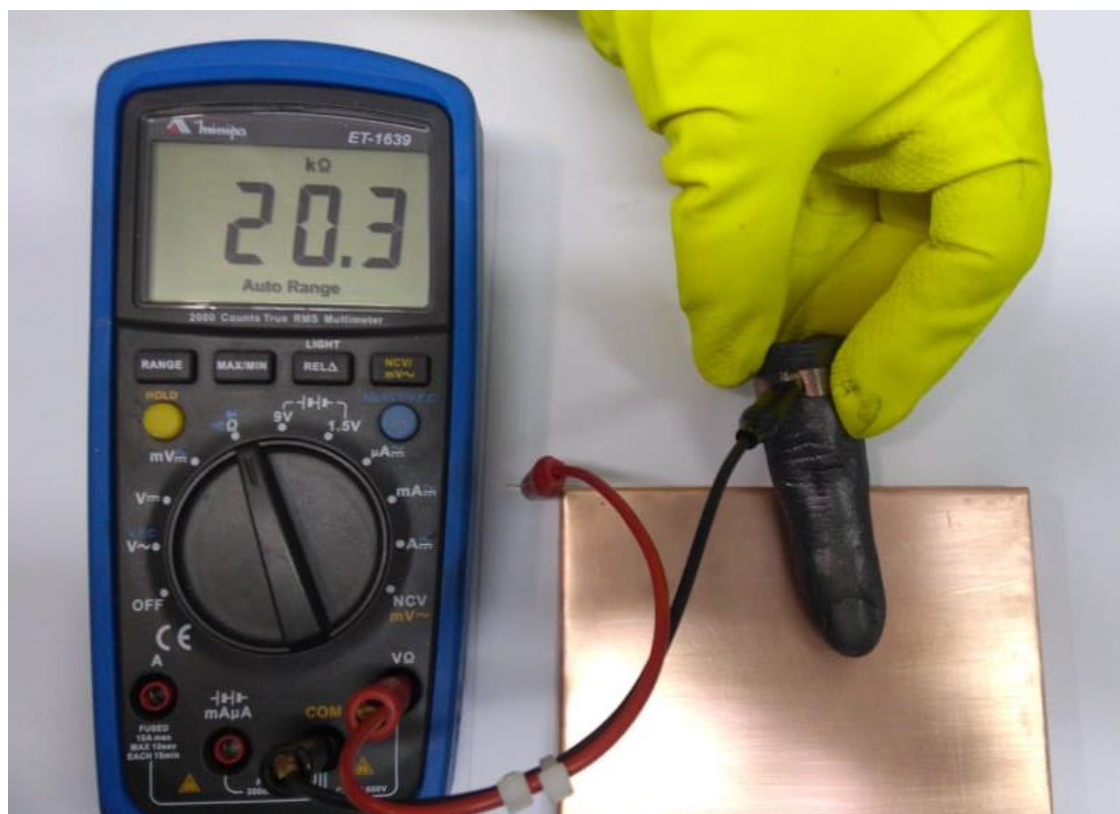
Figura 147 – Medição da resistência elétrica do Dedo Phantom . Fonte: autoria própria/Luiz A. F. dos Santos.
