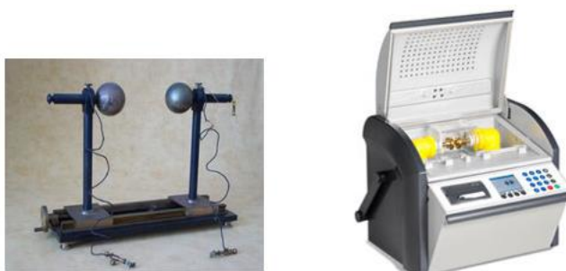
Figura 94 – Espinterômetro antigo à esquerda e moderno à direita. Fonte: EcuRed.
