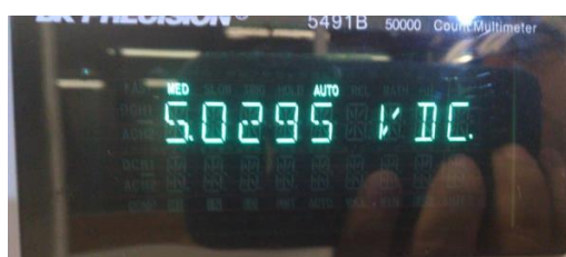
Figura 131 - Tensão no Braço A da célula em relação a massa ( V_{cel} =10V). Fonte: autoria própria/Luiz Antonio Ferreira dos Santos.
