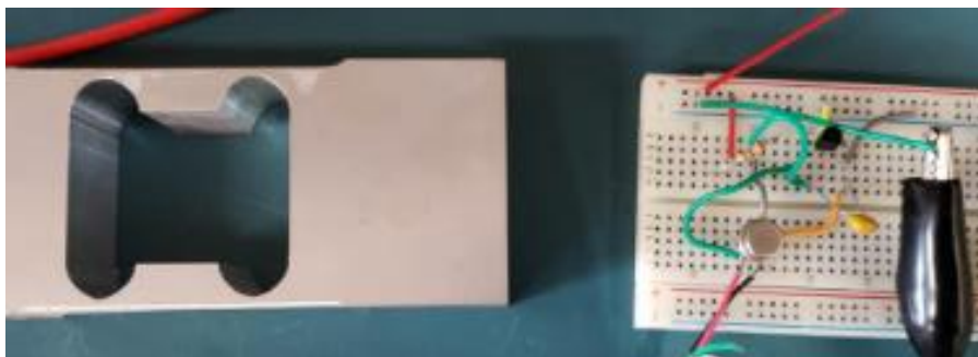
Figura 126 - Ensaio c/ o circuito LH007 e BC327 com a Célula de Carga. Fonte: J. Mello e E. Custódio.
