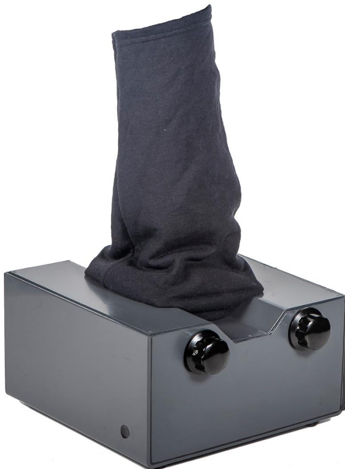
Figura 76 – Porta-filme que opera em conjunto com a unidade de controle. Fonte: autoria própria/L. A. Rebello/Foto: Rodrigo Leal.
