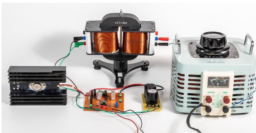
Figura 80 – Ensaio do regulador AT com o varivolt. Fonte autoria própria/Foto Rodrigo Leal.
