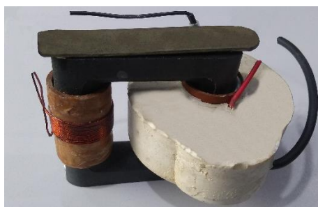
Figura 31 – Transformador elevador de tensão (MAT) tipo Fly-Back. Fonte: Luiz Lafersan.
