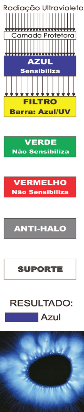
Figura 180 – Ação da camada de filtro UV/Azul interno do filme. Fonte: autoria própria.
