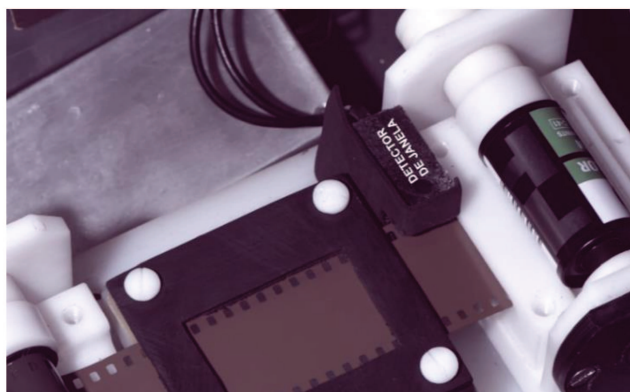
Figura 112 - Base do porta-filme com o detector de janela. Fonte: autoria própria/ Luiz Antonio Ferreira dos Santos /Foto: Rodrigo leal.
