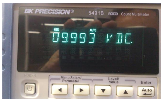
Figura 129 - Tensão de alimentação da célula de carga ( V_{cel} )= 9,993 V). (A precisão do Multímetro BK Precision 5491B é de 0,02%-vide manual). Fonte: autoria própria/Luiz Antonio Ferreira dos Santos.
