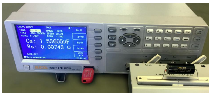
Figura 36 –Ponte LCR Euclid U2837. Medição de resistência série ( R_s ). Fonte: autoria própria.
