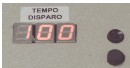
Figura 137 - Display do temporizador com botões de programação do tempo (Painel da Unidade Controladora). Fonte: Luiz A. Rebello.
