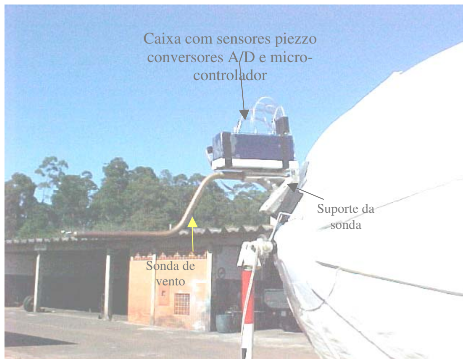
Figura 32: Fixação da sonda de vento na proa do dirigível.
