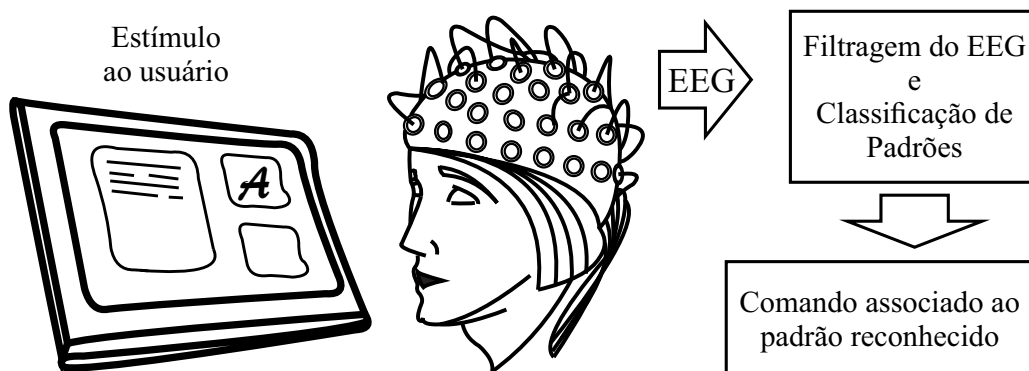
Figura 2.4: Etapas de um sistema de BCI (exemplificado com um aparelho g.tec).
