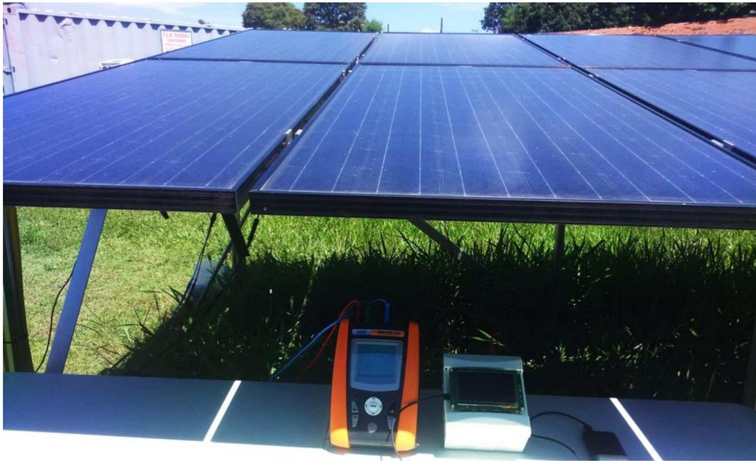
Figura 4.32: Equipamento Solar I-Ve (esquerda), protótipo desenvolvido (direita) e módulos de uma string FV localizada no CIS Guanabara-UNICAMP.
