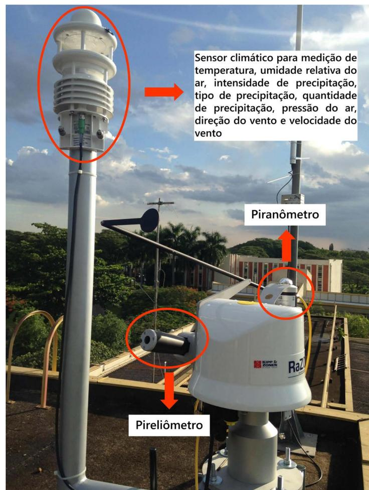
Figura 2.6: Estação solarimétrica instalada no Prédio da Fec na Unicamp.
