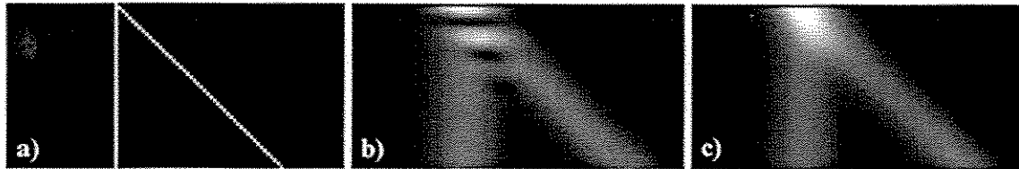
Figura 2.9 – Dependência do "speckle" com a distância entre os espalhadores: a) estrutura; b) imagem de modo-B (envelope) e c) imagem de modo-B livre de "speckle".
