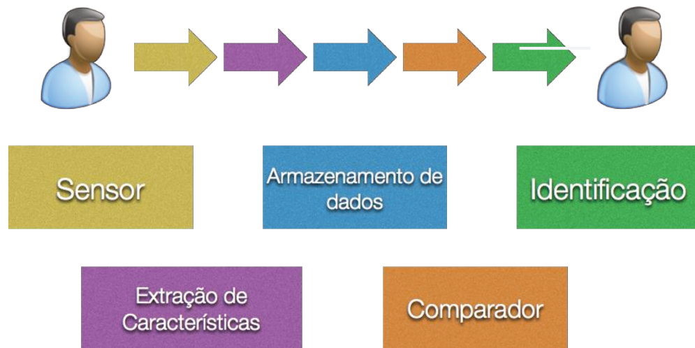
Figura 3.9 Etapas de um sistema biométrico.
