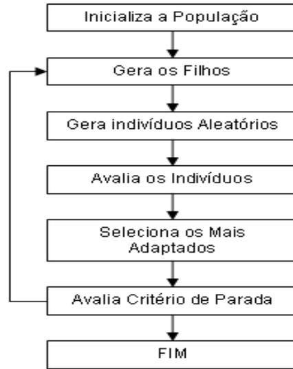
Fig. 3.8: Esquema de Funcionamento da EE
