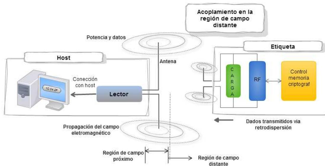
Figura 2.4: Funcionamiento de un sistema RFID pasivo por a retrodispersión
