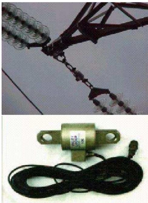
Fig. 4.5: Sensor de tração mecânica
